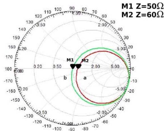
FIGURE 3.28 – Abaque de Smith de l’AHC a) avec ou b) sans plot, M1 et M2 marqueurs à 1,575GHz.
