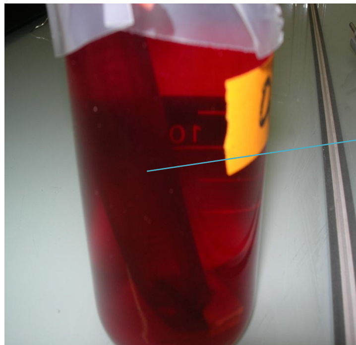
Figure A.I.2 : Béchers contenant les sacs de dialyse (la couleur rouge est due au transfert des anthocyanes à travers les pores des sacs de dialyse)
