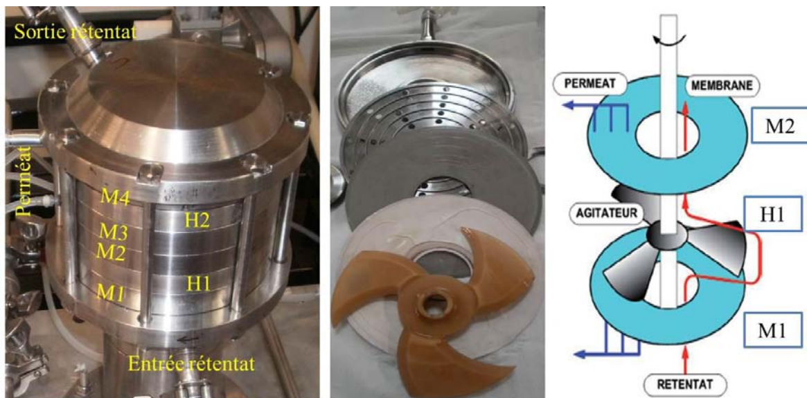
Figure V.3: Le module RVF contenant 4 membranes (M1, M2, M3 et M4) et 2 hélices (H1 et H2).
