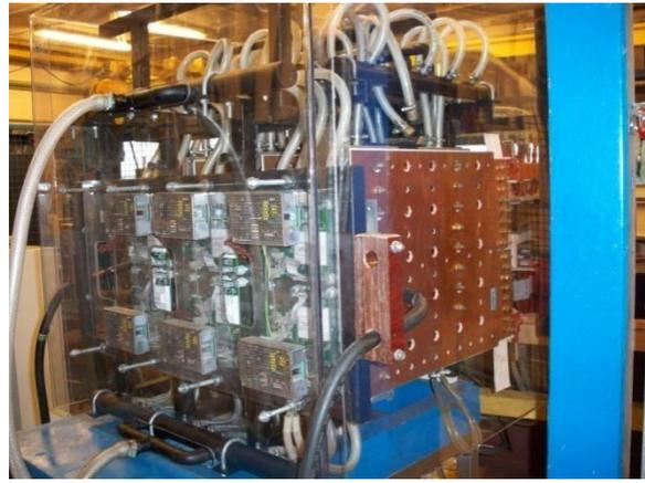
Figure 2-3 : onduleurs de la maquette et jeux de barre de fixation des condensateurs (vue de gauche de la Figure 2-2)
