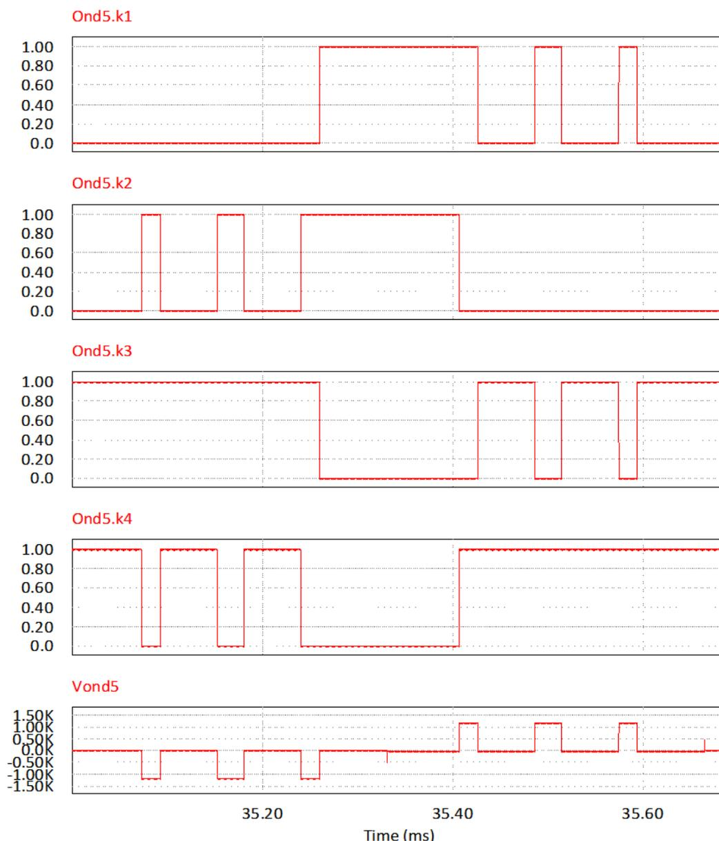
Figure 4-62 : signaux de commande des interrupteurs de l'onduleur 5 pour l'élimination de 2 harmoniques
