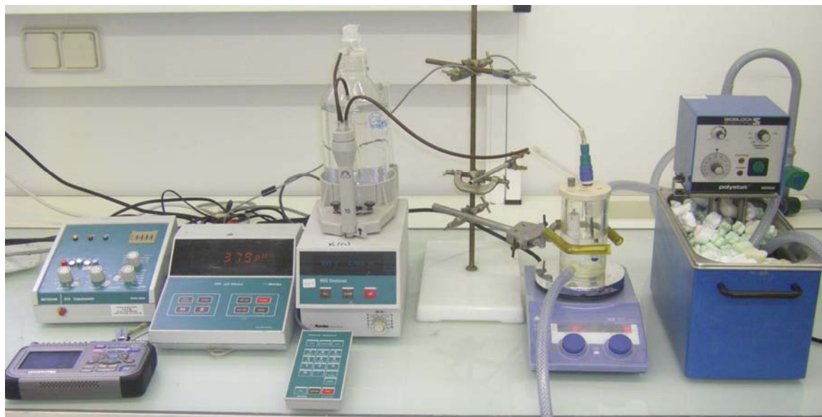
Figure 3.47 : Photographie de l'installation de pH-stat utilisée pour l'étude de la dissolution des dépôts
