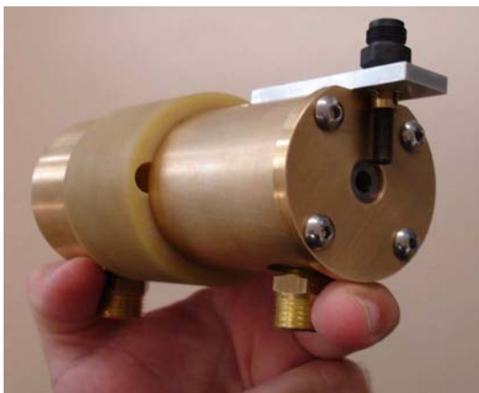
Figure 3.1 : Photographie de la mini-torche (MTBE) pour la projection plasma à basse énergie
