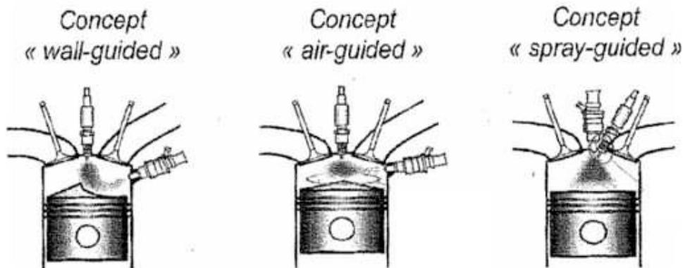
FIGURE 4 - Technologies d'injection du carburant pour l'injection directe.
