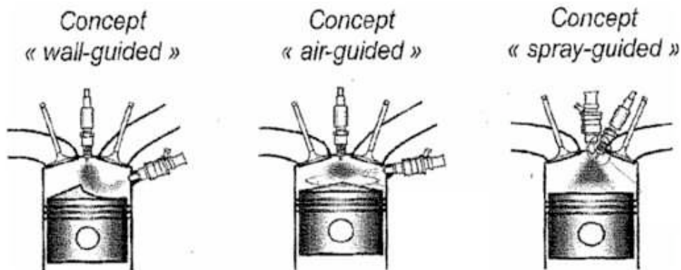
FIGURE 4 - Technologies d'injection du carburant pour l'injection directe.
