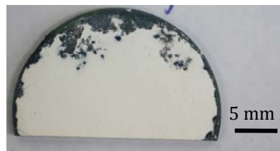
figure XIX-6: Photographie d'un échantillon après 500 cycles à 1100°C
