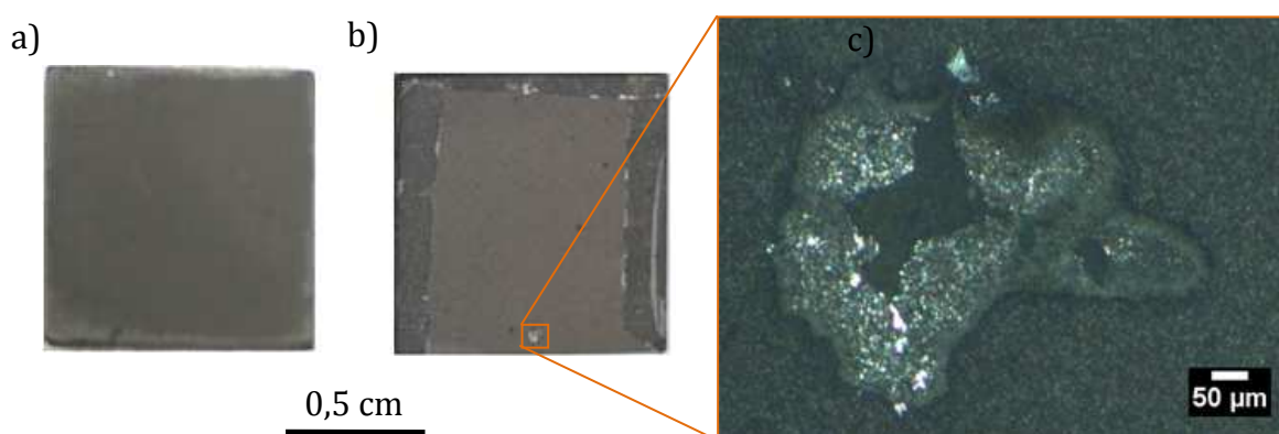
figure XIII-2 : Echantillon 3D après ATG à 1100°C sous air synthétique pendant 100h
