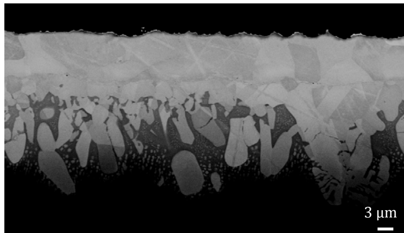
figure XI-4 : Echantillon 5/2 après SPS et recuit de 5h à 1100°C
