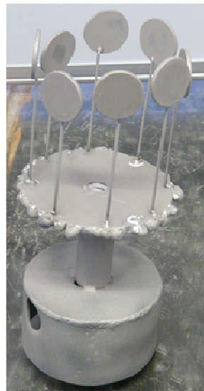
figure IV-1 : Echantillons soudés sur le porte objet avant dépôt EBPVD
