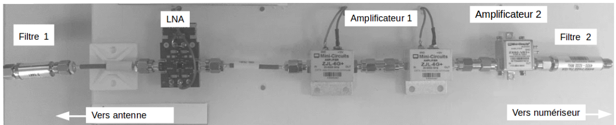
FIGURE 3.20 – Maquette prototype du récepteur du système de transmission sans fil
