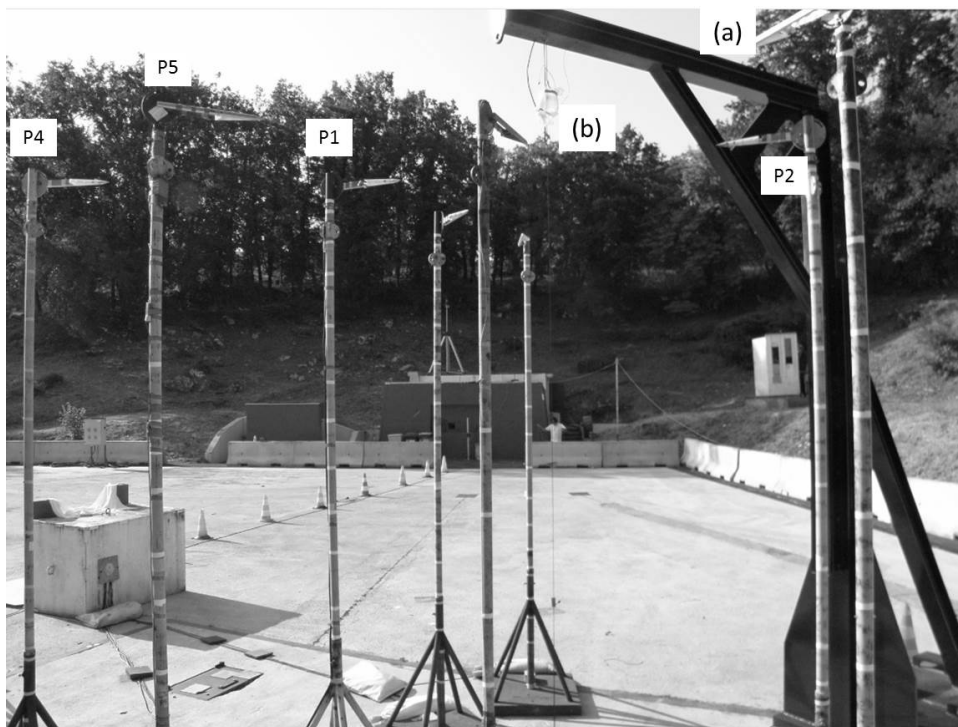
FIGURE 4.8 – Vue du site d'expérimentation avec explosif; avec (P1-P5) les différent mâts, (a) la potence et (b) l'emplacement de la charge explosive
