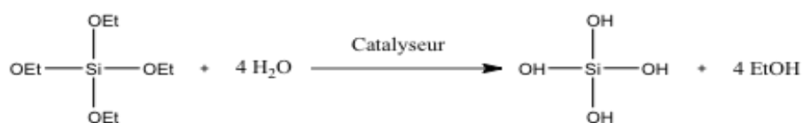
Figure 16 : Réaction d'hydrolyse des alcoxydasilanes
