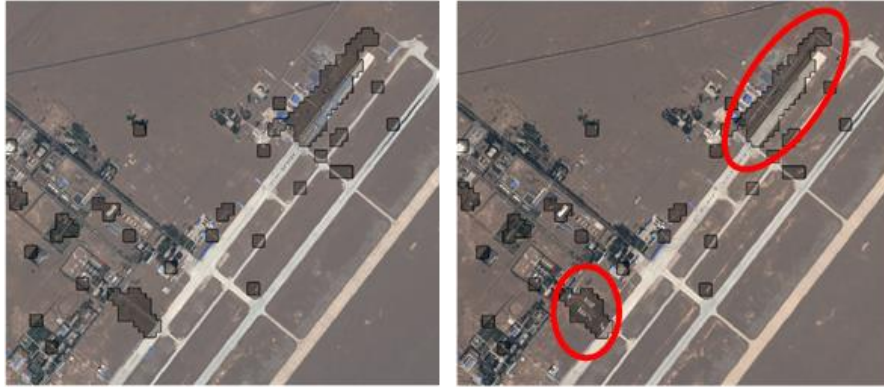
Figure 22: Détection de changement sur un aéroport en Chine. Divers changements sont détectés mais les changements significatifs issus de construction sont accentués. Source
