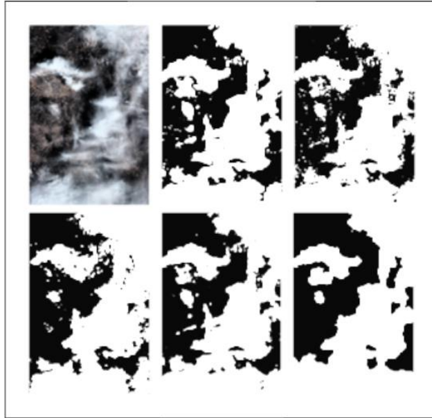
Figure 77: Résultats de classification sur une image pour les différents descripteurs. En haut, de gauche à droite, l'image initiale, le masque de nuages, la prédiction avec les valeurs brutes. En bas, de gauche à droite, la prédiction avec les ratios, avec le CNN, avec les superpixels. (Le Goff M., Tourneret J-Y et Wendt W., et al. 2017)
