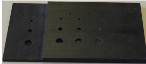
FIGURE 2.4 – Photo du matériau monolithique avec trous à fond plat
