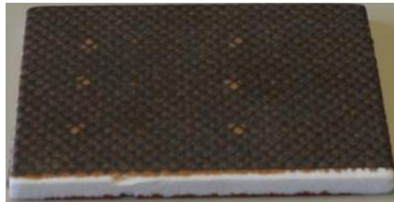
FIGURE 2.7 – Photo du matériau sandwich avec inserts Téflon ® (peaux de 0.66 mm)
