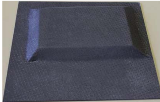
FIGURE 2.10 – Photo du matériau sandwich avec inserts Téflon ® (peaux de 1.08 mm)
