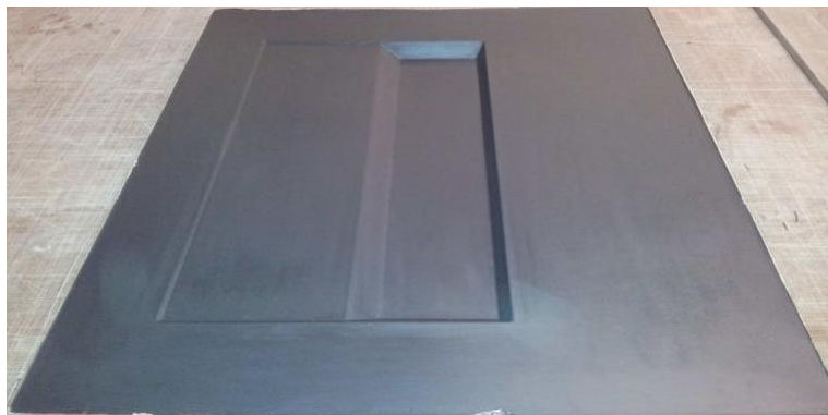
FIGURE 2.15 – Moule rigide en verre-époxy
