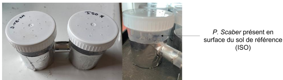
Figure 33 : Photographies du dispositif expérimental mis en place pour la réalisation des tests d'évitement sur P. scaber
