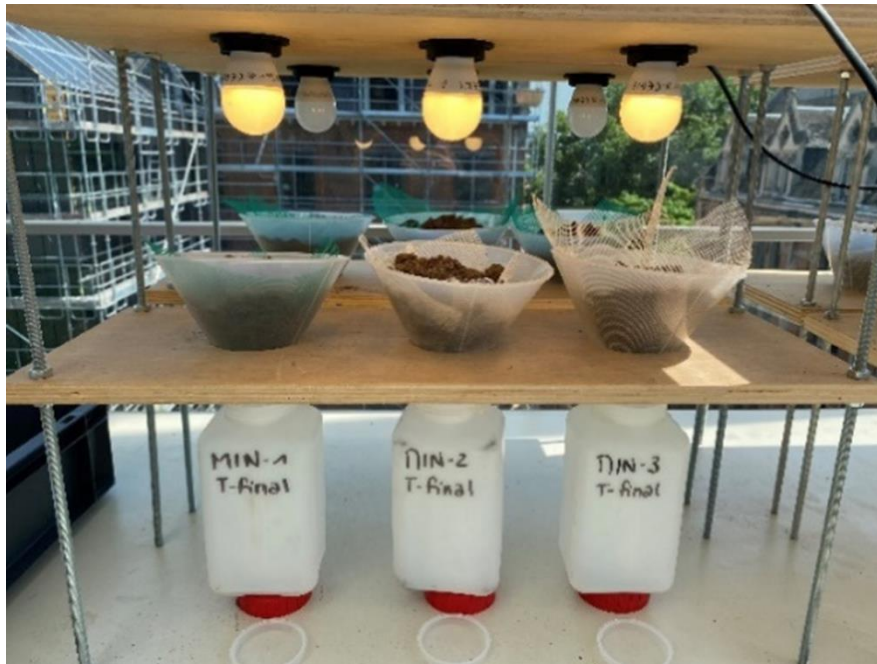
Figure 39 : Photographie du dispositif permettant l'extraction de la mésofaune
