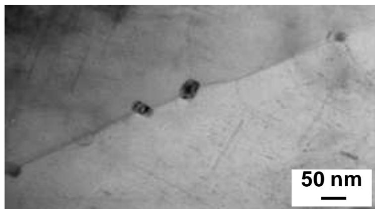
Figure V-28 : Observation au MET d'un joint de grain de l'alliage AA 6101 + e = 20% + 185°C-10h
