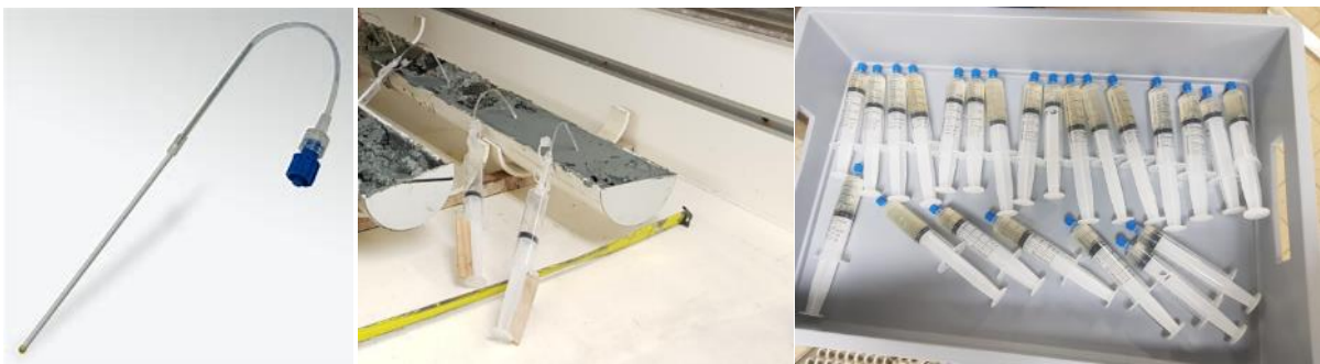
Figure 2.6: Illustration du prélèvement des eaux interstitielles à l'aide d'échantillonneurs Rhizon
