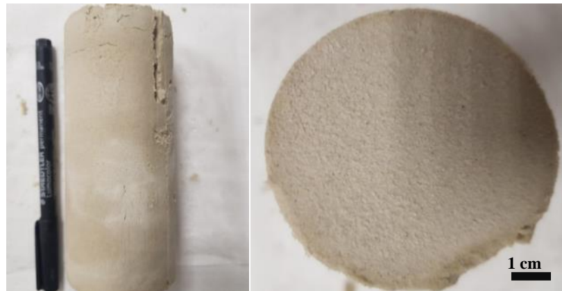
Figure 4.3 : Hydrates synthétisés dans une matrice à 15,2 % MMT/84,8 % sable (équivalent à 10% d'argile) à ~ 52 % de saturation eau
