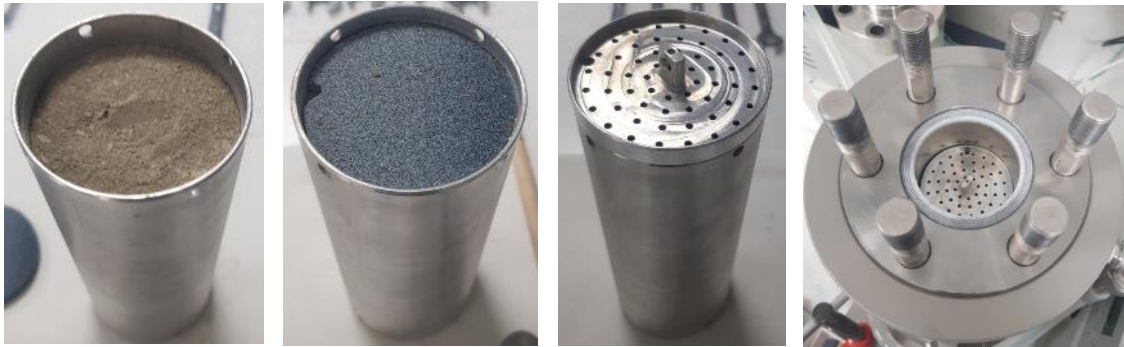
Figure 2.3: Images de la cellule en aluminium utilisée pour la préparation des carottes sédimentaires.
