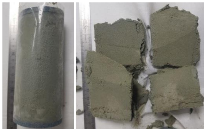
Figure 4.2 : Hydrates synthétisés dans une matrice à 17.9 % ILL/82.1 % sable (équivalent à 10% d'argile) à ~52% de saturation en eau. Le changement de couleur de la matrice est clair, et atteste de l'ajout d'argile riche en illite.
