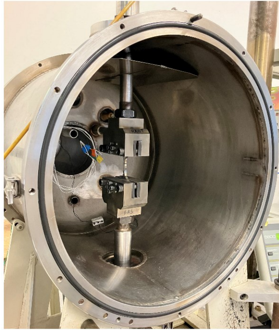
Figure II-15 : Enceinte permettant de faire le vide à 6.10^{-4} Pa.
