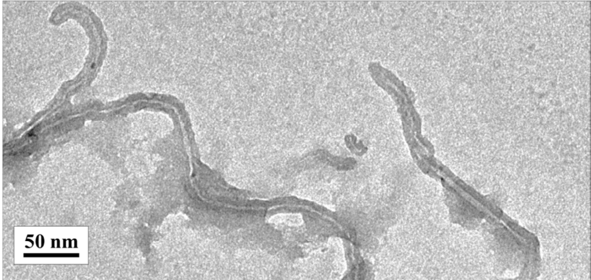
Figure 8 : nanotubes de carbone multi-paroi (MWNTC) observés en microscopie électronique à transmission (MET ; JEOL JEM-1400, 120kV, JEOL, Tokyo, Japon) après 20 mn de dispersion par ultrasons en présence de matière organique naturelle (MON ; ratio 10 mg L -1 de MWNTC pour 10 mg L -1 de MON) on peut remarquer les MWNTC entièrement recouverts par la MON contrairement à la Figure 6. (Photo : L. Verneuil EcoLab).
