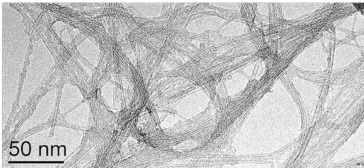
Figure 5 : Nanotubes de carbone double paroi (DWNTC) utilisées pendant cette étude (lot : CNT260310, Institut Carnot Cirimat). On peut remarquer l'enrobage de ces derniers par de la MON de la rivière Suwannee (1R101N, International Humic Substances Society, IHSS USA ; Photo : L. Verneuil, EcoLab) Pour plus de détail de l'enrobage de MON voir Chapitre 5 Figure 1.
