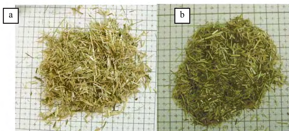
Figure III-23 : Agrofibres de Foin des Marais obtenues par défibrage mécanique a – Agrofibres longues obtenues par défibreuse Cadette 1000 ; b – Agrofibres obtenues par broyage
