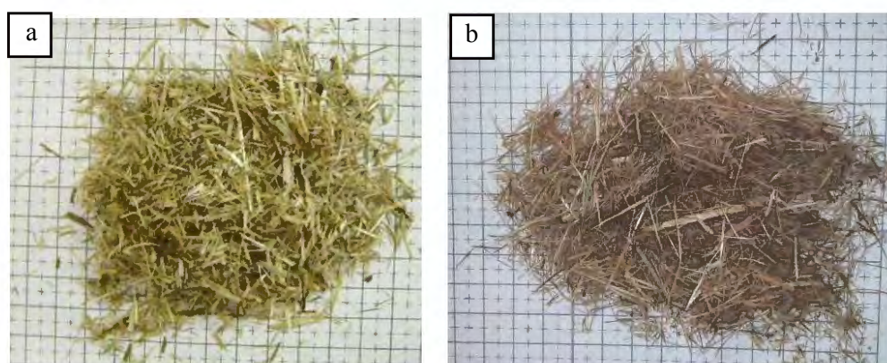
Figure III-36 : Agrofibrilles de Foin des Marais obtenues par défibrage mécanique à différentes humidités
