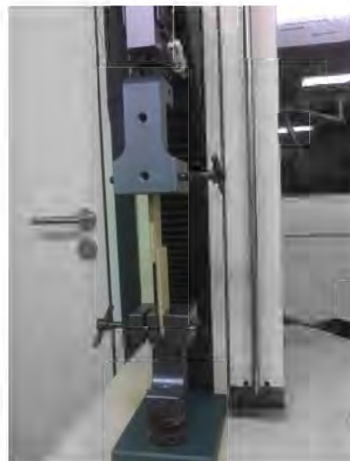
Figure A.VI-8 : essais en traction pour la détermination du pouvoir collant sur le banc d'essai JFC modèle H5KT
