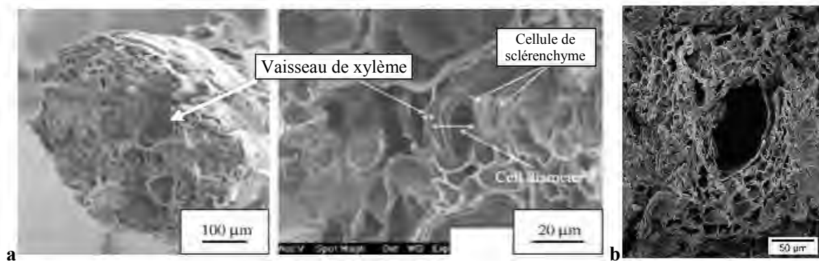
Figure I-48 : Agrofibrilles composées de faisceaux cribro-vasculaires en coupe transversale
