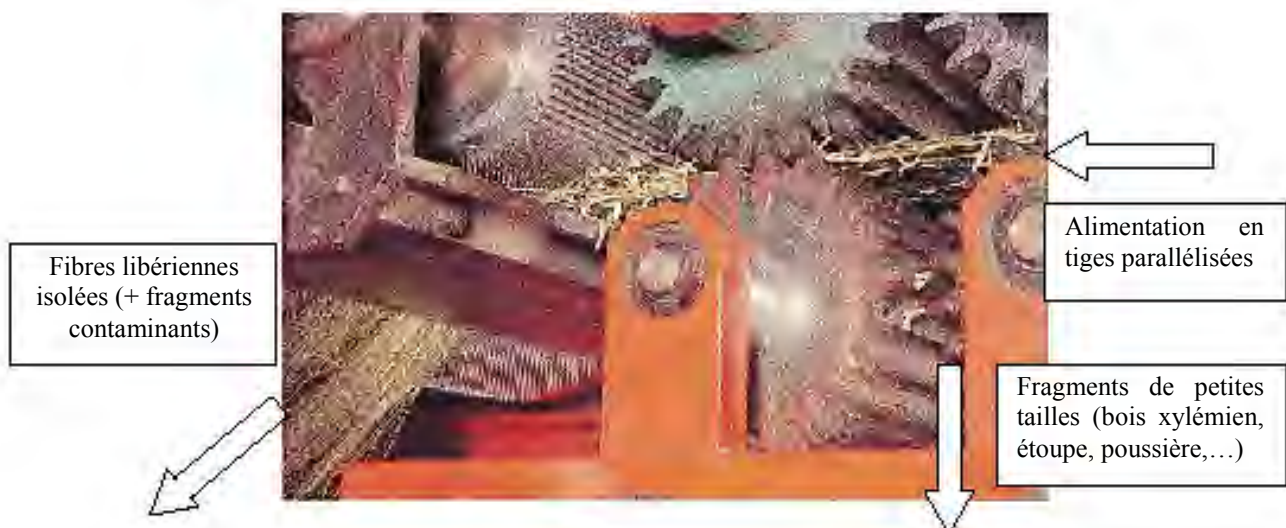
Figure I-69 : Décortiquage par rouleaux cannelés co-rotatifs (Hobson et al. 2001)
