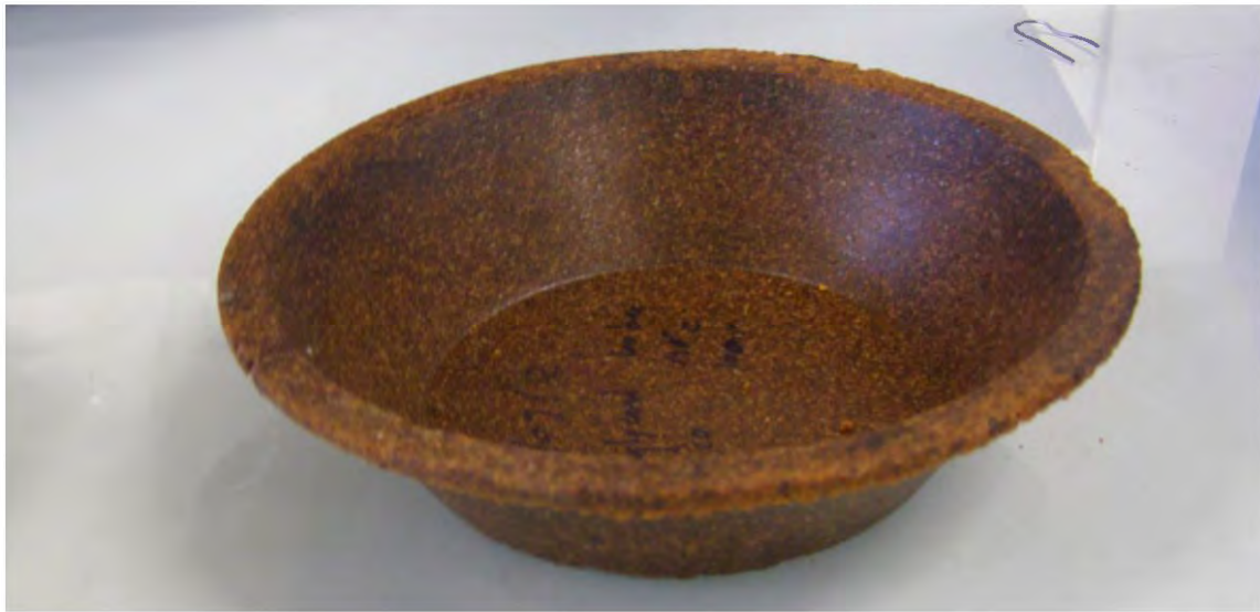
Figure V-24 : Ecuelle de Mélilot réalisée par thermomoulage
