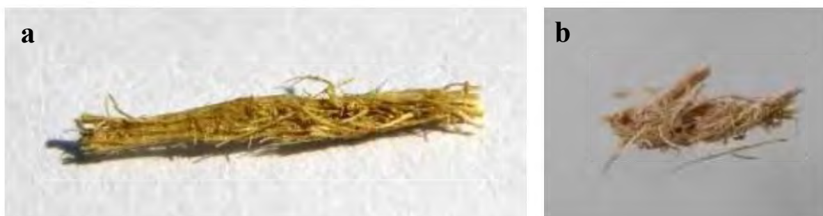
Figure III-49 : Agrandissements numériques de fragments après défibrage thermo-mécanique a – Rouche (D9) ; b – Foin des Marais (D8)
