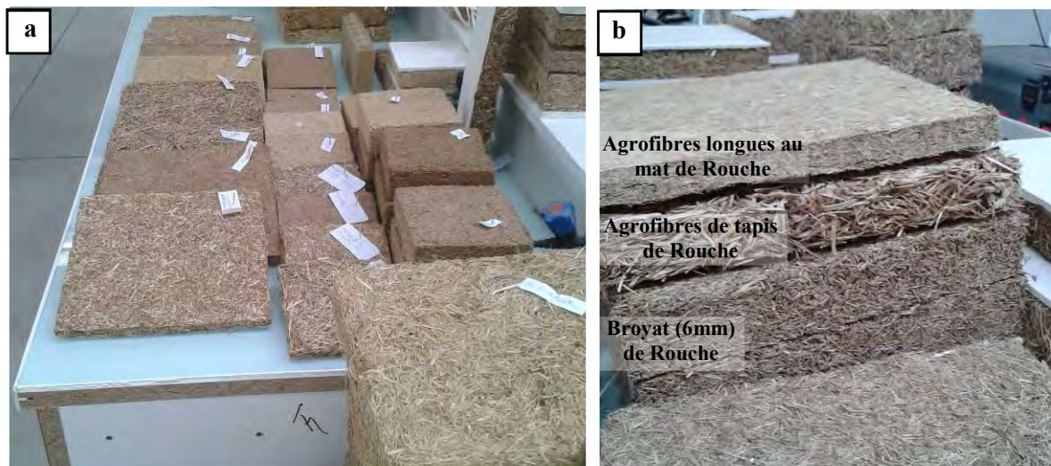
Figure IV-5 : Agromatériaux peu denses encollés à la colle de caséines
