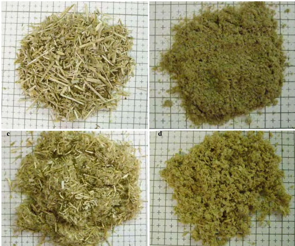
Figure III-48 : Agrofibres issues d'un défilage thermo-mécanique de Canne de Roseau et de Mélilot blanc
