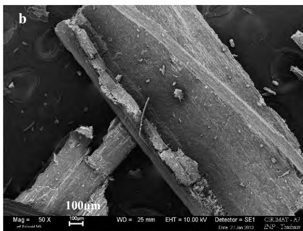
Figure III-3 : Observation au MEB d'agrofibres broyées de Foin des Marais
