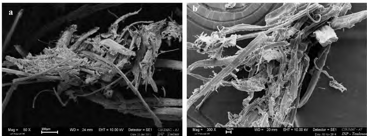
Figure III-54 : Observation au MEB de pelote d'agrofibrilles obtenues par défibrage thermo-mécanique en extrudeur bi-vis
