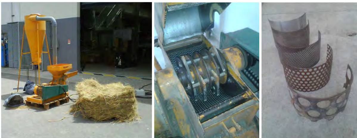
Figure III-1 : Broyeur à marteaux Electra VS1 utilisé durant les travaux
