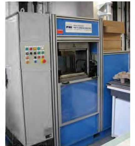
Figure A.VI-2 : Thermopresse hydraulique MAPA 50
