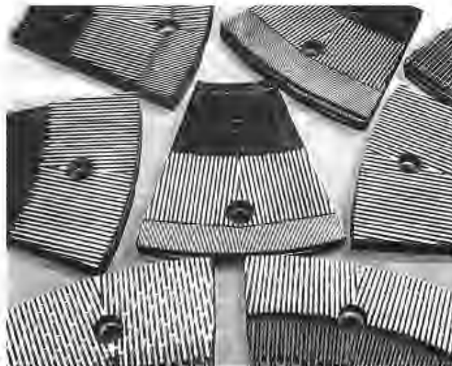
Figure I-72 : Modèles de segments de disques de raffineurs utilisés pour la fabrication de pâtes mécaniques. (Petit-Conil 1999)
