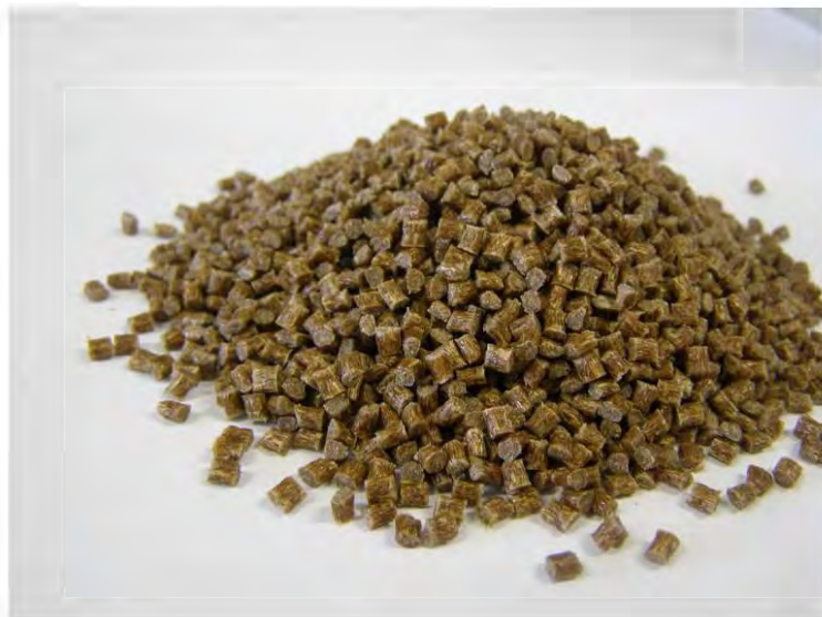
Figure IV-50 : Compound de PP-PPMA/Foin des Marais micronisé importé 40% massique
