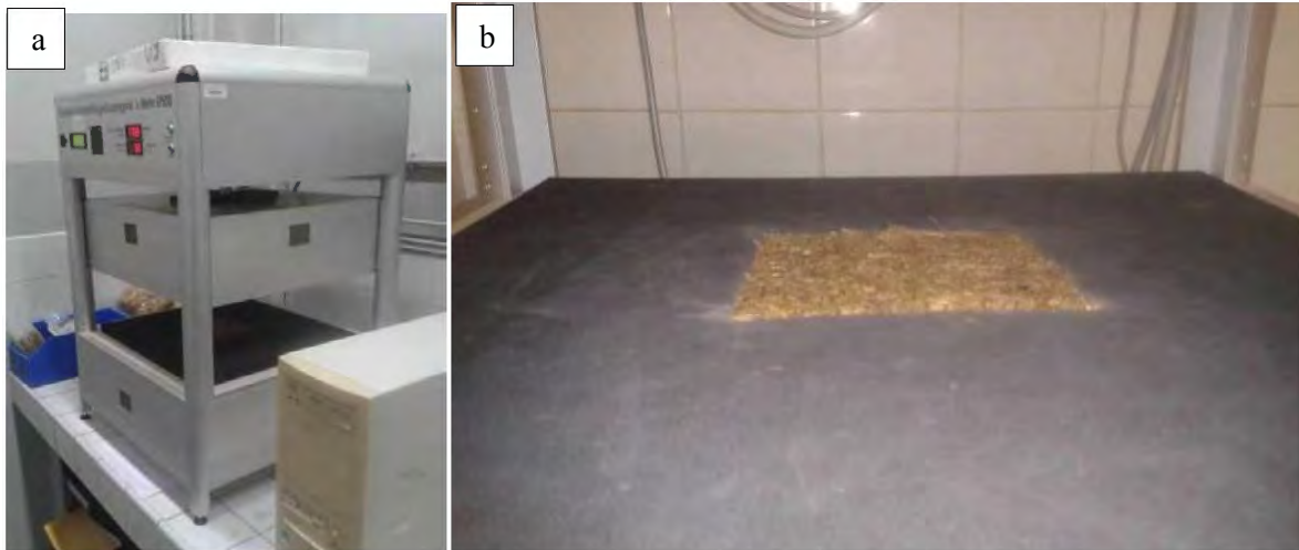
Figure A.IV-1 : Mesure de conductivité thermique par la méthode de la plaque chaude gardée a – Plaque chaude gardée à un échantillon \lambda -Meter EP 500 ; b – Echantillon d'agrofibrés (broyat de Rouche) dans une boîte PVC (sans couvercle) placé dans un cadre isolant en mousse de polyuréthane
