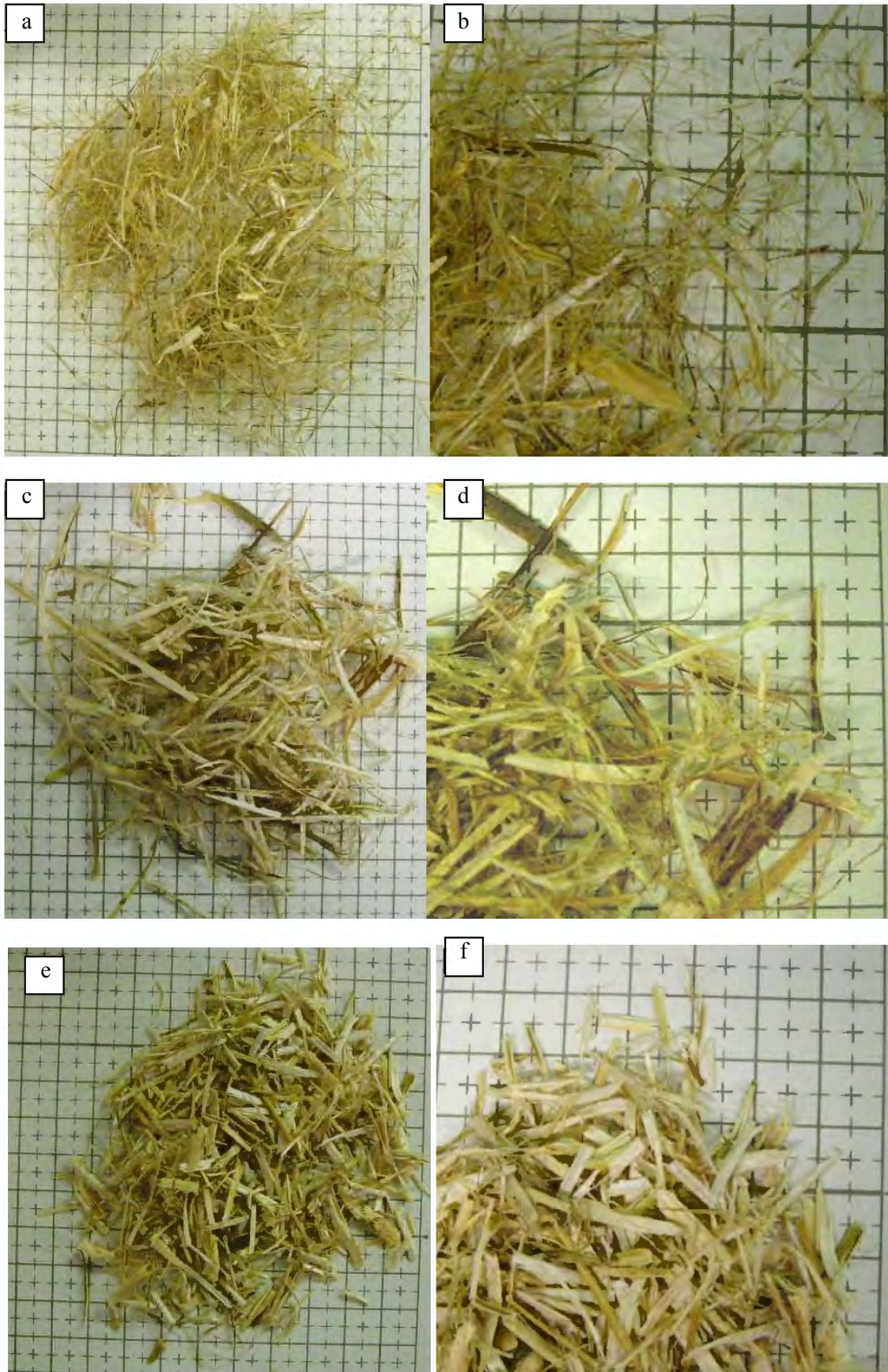
Figure III-28 : Fractions fibreuses de Mélilot jaune obtenues en défilage Cadette a et b – Fractions d’agrofibrés longues ; c et d - Fractions d’agrofibrés de tapis (fonctionnement en évacuation) e et f - Fractions d’agrofibrés de tapis (fonctionnement en recyclage)
