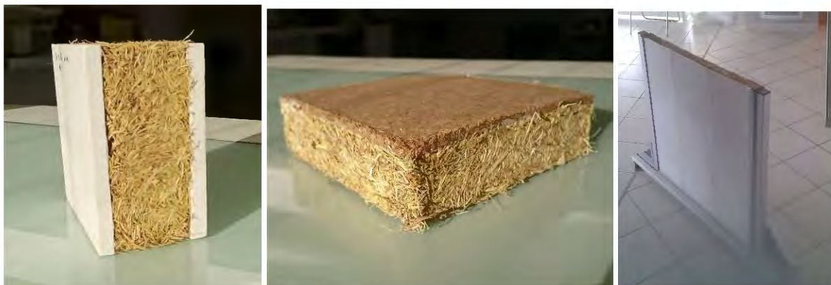
Figure IV-10 : Prototypes d'élément de cloison associée avec un panneau d'agrofibre
