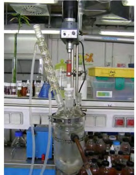
Figure A.VII-1 : Réacteur agité à double enveloppe utilisé
