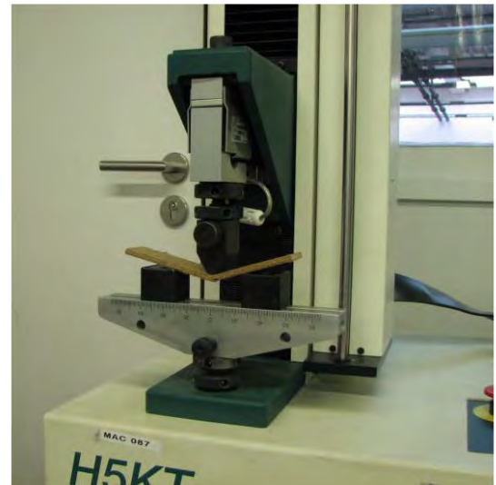
Figure A.VI-7 : banc d'essai JFC modèle H5KT, configuré pour la mesure de flexion trois points
