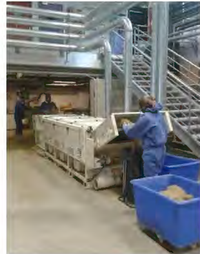
Figure A.V-2 : Équipement pilote ouvreuse-défibreuse Cadette1000
