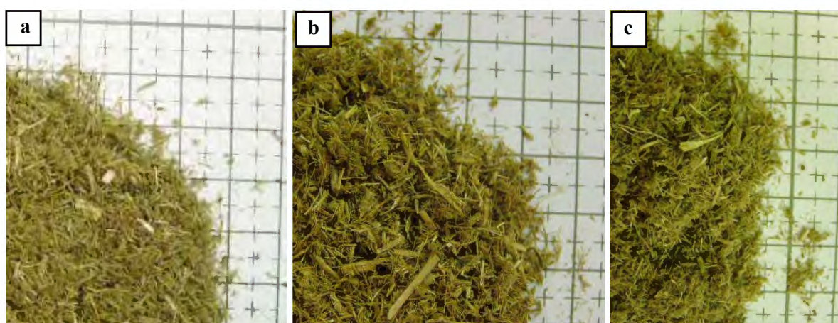
Figure III-74 : Agrofibrilles de Rouche obtenues par défibrage thermo-mécano-chimique a – Défibrage thermo-mécanique; b – Défibrage thermo-mécano-chimique avec extraction à l'eau ; c – Défibrage thermo-mécano-chimique avec extraction alcaline
