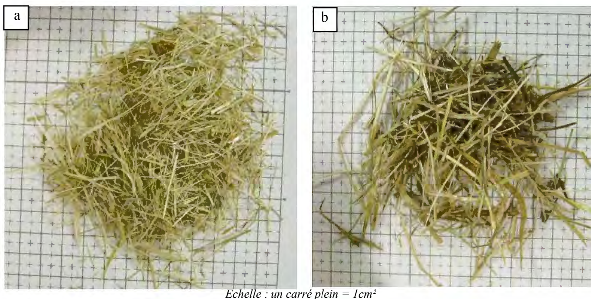
Figure III-25 : Fractions fibreuses de Rouche obtenues en défibrage Cadette a – Fractions d'agrofibrilles longues ; b - Fractions d'agrofibrilles de tapis
