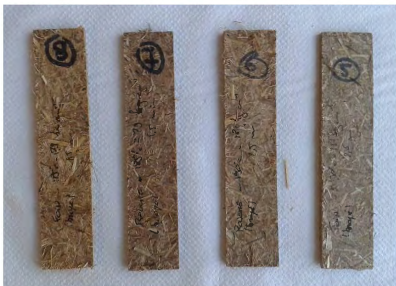
Figure III-14 : Epreuves d'agrofibrés issues du broyage de Foin des Marais et de Rouche thermopressées
