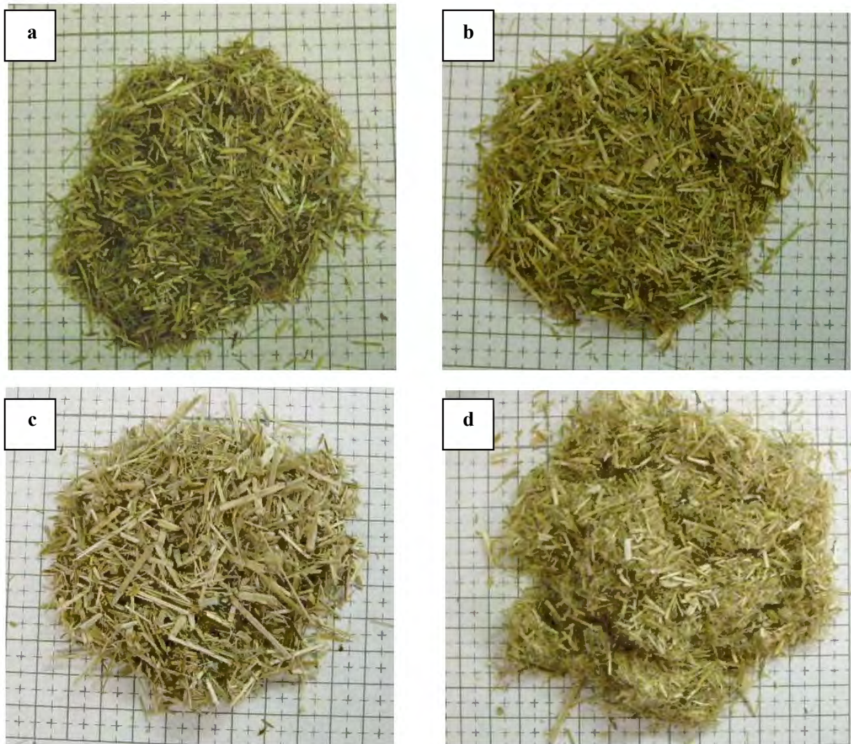
Figure III-2 : Biomasses broyées avec une grille de calibrage de 6mm
