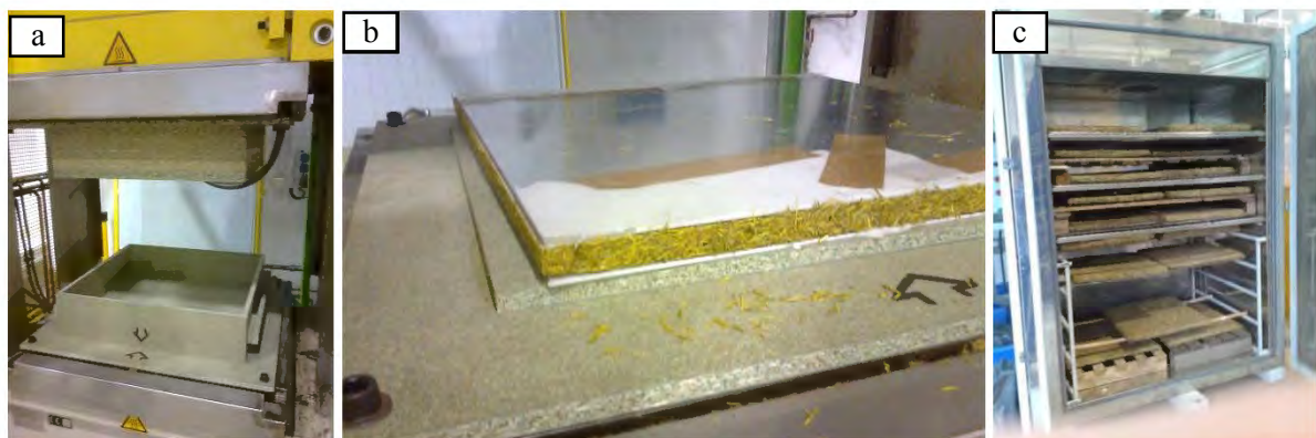
Figure A.VI-4 : Préparation des dalles de plafond
