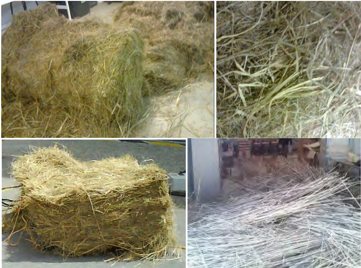
Figure II-10 : Balles de Rouche et Foin des Marais et javelle de Roseaux utilisées lors de l'étude a – Balle de Rouche (lot 2012); b – Détail de la balle de Rouche : feuille de Glyceria maxima sèche ; c - Balle de Foin des Marais (lot 2010), d – Javelle de cannes de Roseaux récoltés manuellement (2013)
