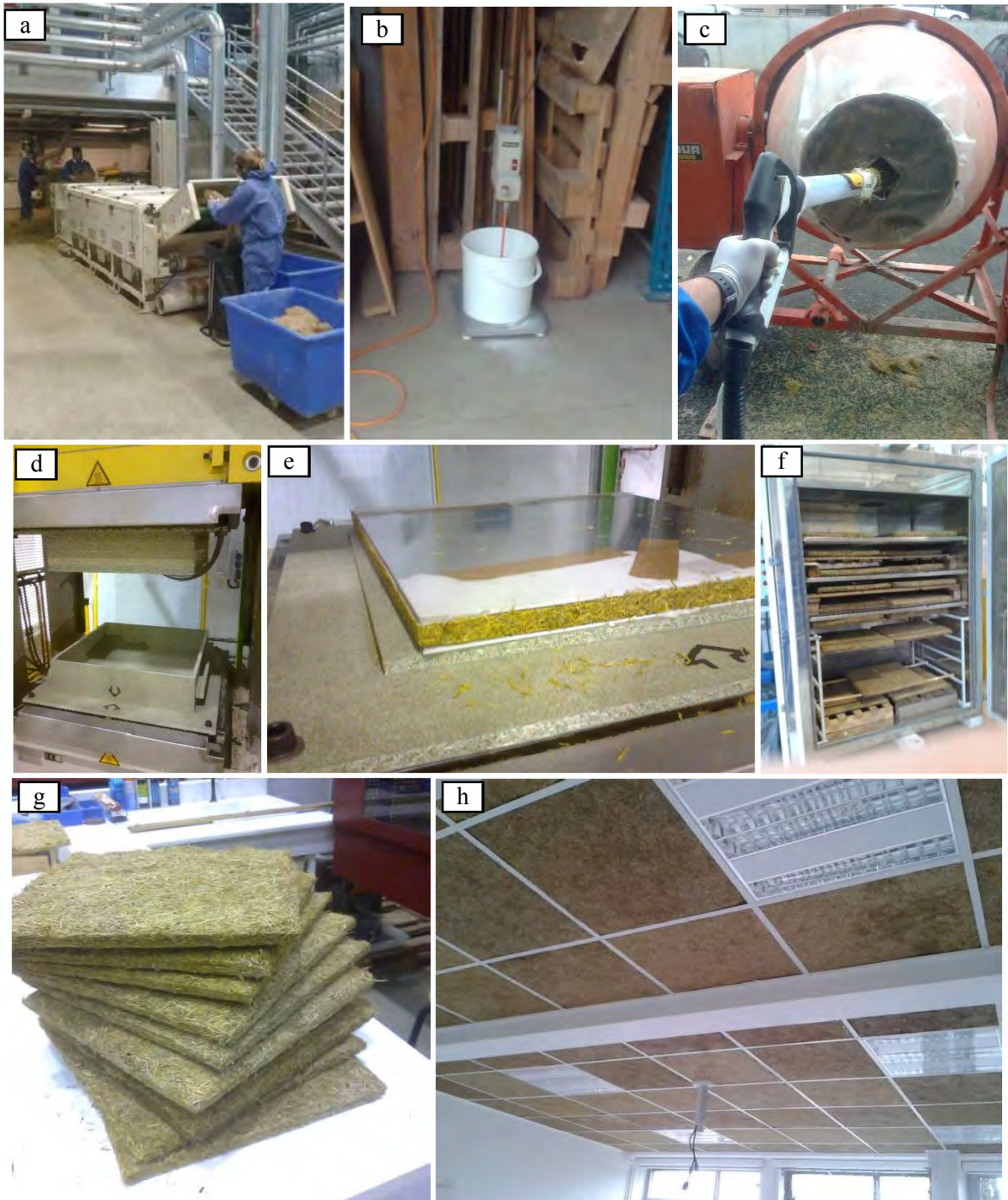
Figure IV-12 : Production de dalles de faux-plafond agrossourcées produites par des agrofibrilles longues de Rouche obtenues par défibrage mécanique orienté et encollées à la colle de caséines a – Production d’agrofibrilles longues au mat par défibrage mécanique orienté en équipement pilote Cadette 1000 ; b – Préparation de la colle ; c – Ensimage des agrofibrilles longues au mat de Rouche dans le mélangeur rotatif à pales fixes ; d –Moule fermé en bois de 40x40cm utilisé pour la mise en œuvre, monté sur la presse PEI 400T ; e – Agrofibrilles encollées à la colle d’os après mise en forme ; f – Séchage des dalles en étuve ventilée ; g – Présérie de dalles de plafond ; h – Faux-plafond installé dans le local de démonstration de la CCCE
