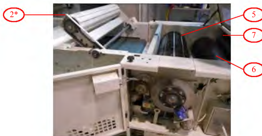
Figure A.V-3 : Schéma de fonctionnement de l'équipement pilote ouvreuse-défibreuse Cadette1000
