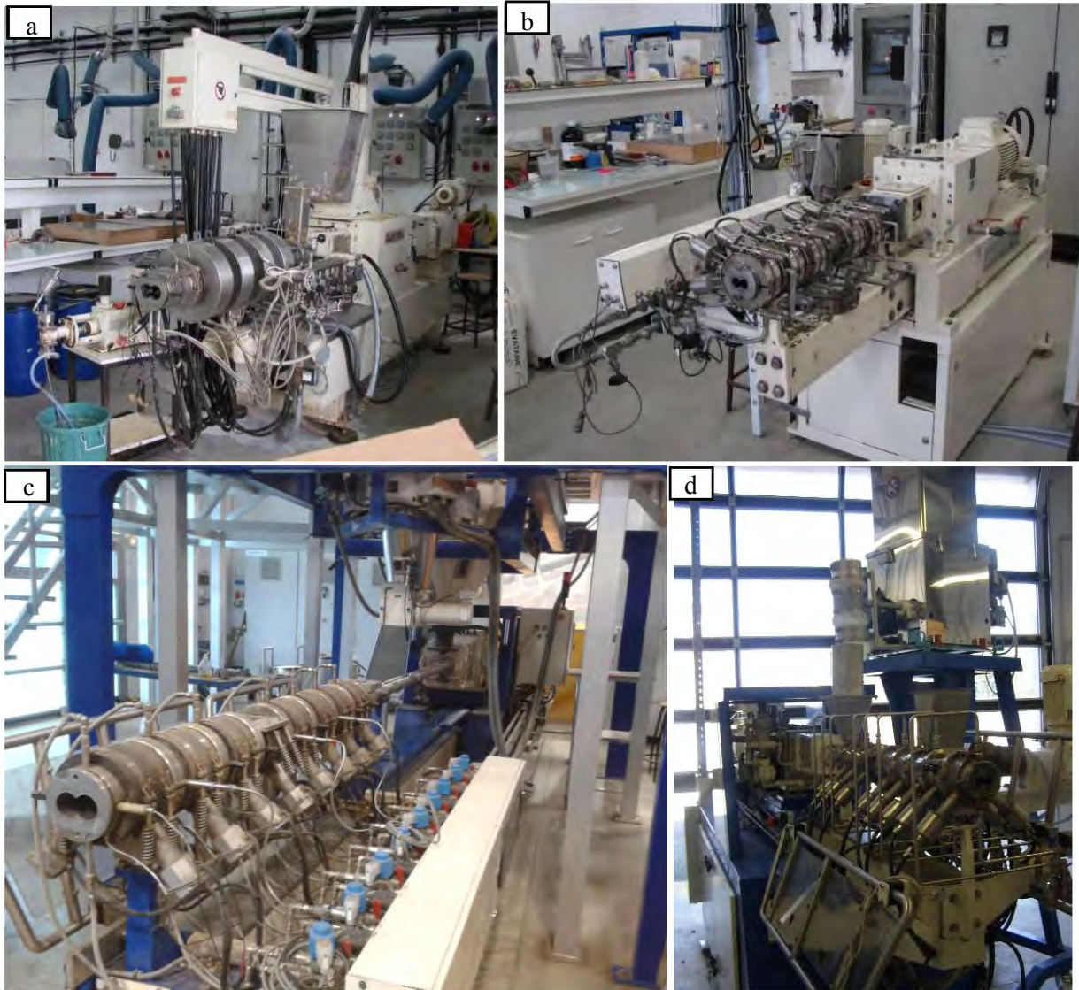
Figure A.V-4 : Extrudeurs bi-vis Clextal utilisés durant ces travaux
