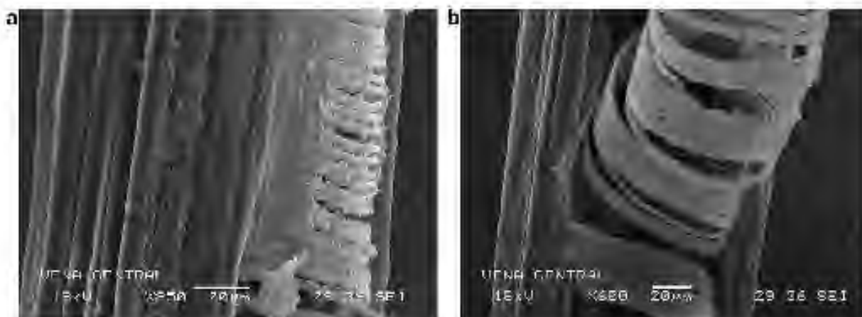
Figure I-66 : Faisceau cribro-vasculaire de la gaine foliaire de bananier (Gañán et al. 2008)
