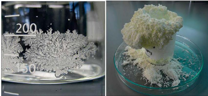
**Figure 5.2.** – Deux exemples de dépôt cristallin sur les parois des récipients (images tirées de van Enkevort and Los [2013]).
