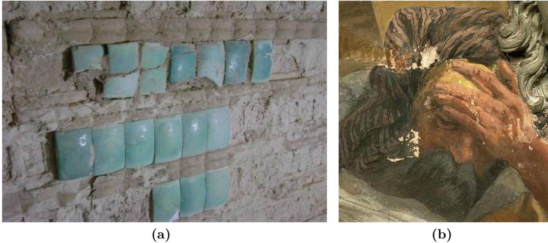
**Figure 1.1.** – Dans ces images, nous pouvons observer des exemples de dégradation liée à l'évaporation d'une solution saline aqueuse en milieu poreux. **(a)** Photographie de la faïence dégradée se trouvant dans la tombe du roi Djoser à Saqqarah en Égypte [Madkour and Khallaf, 2012]. **(b)** Fresque de Tiepolo dans la Résidence Würzburg en Allemagne présentant des dégradations à la surface liées à des formations salines <sup>1</sup>.
