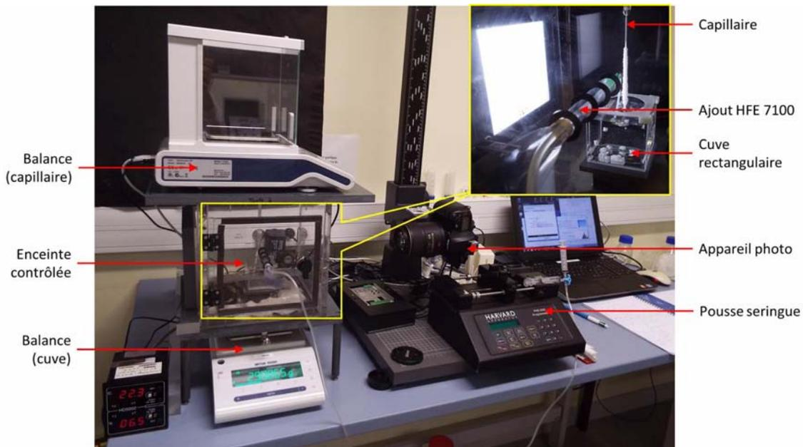
Figure 5.8. – Vue d'ensemble du dispositif TSE-SE.
