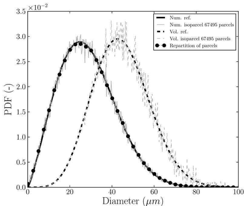
**Figure 7.2 :** Méthode  $iso-N_{ptcl}$  : distribution en nombre et en volume obtenues après injection d'un grand nombre de particules numériques, par rapport à la distribution physique de référence (Rosin-Rammler). La répartition des particules numériques suit logiquement la distribution en nombre dans cette méthode.
