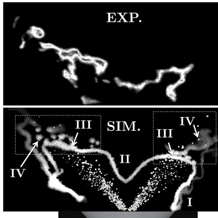
**Figure 11.11** : Cas réactif avec spray. Haut : image instantanée de OH-PLIF, tirée de l'expérience [32]. Bas : champs instantanés de dégagement de chaleur (grey levels) et des gouttes (white) obtenus par LES.
