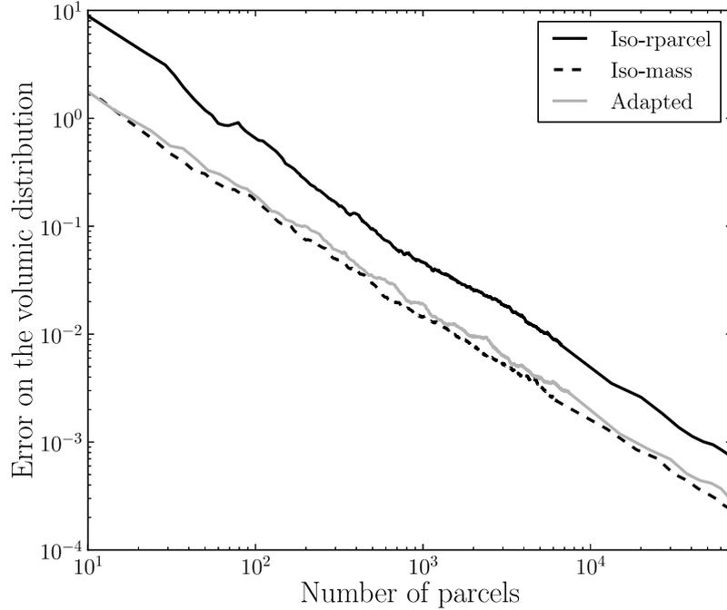
**Figure 7.5 :** Evolution de l'erreur au sens des moindres-carrés sur la distribution **en volume**, en fonction du nombre de particules numériques injectées, pour les trois différentes méthodes. Les valeurs des régressions linéaires sur ces résultats sont données en Tab. 7.1.
