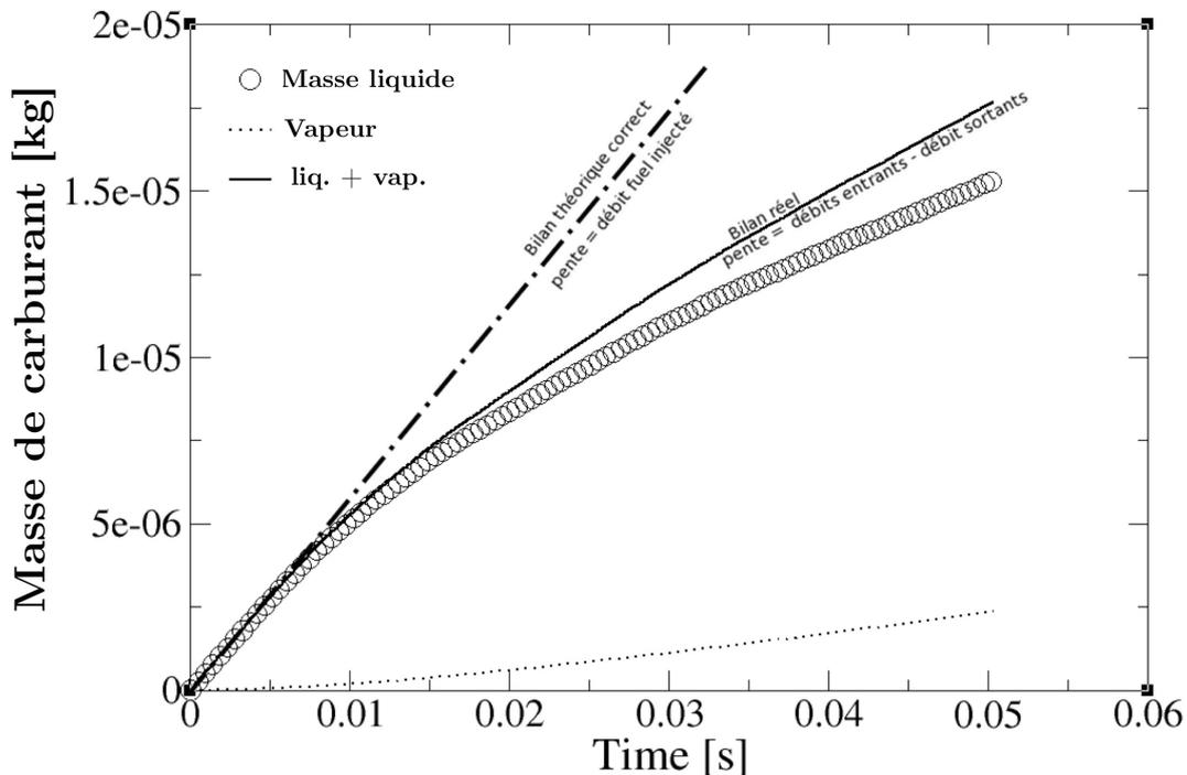
**Figure 5.1 :** Bilan de masse liquide pour une LES-DPS non réactive correspondant au remplissage initial d'une chambre de combustion réelle avant allumage. Une perte de masse de carburant liquide à travers les surfaces parois concaves de la géométrie est mise en évidence, par rapport au comportement attendu (croissance linéaire de la masse de carburant à l'intérieur de la chambre).
