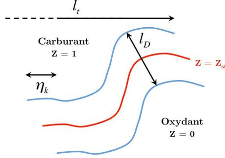
Figure 10.7 : Echelles caractéristiques d'une flamme turbulente non prémélangée.
