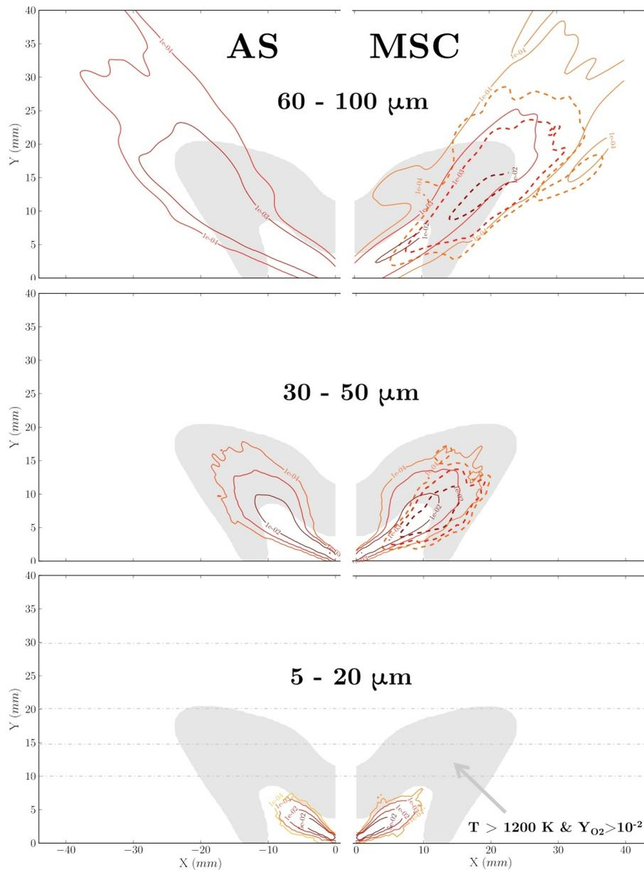
**Figure 12.9 :** Carte de probabilité de présence conditionnée par le diamètre initial et par l'état de la goutte, pour la simulation AS (gauche) et MuStARD (droite) pour trois classes de diamètre *initial*. Lignes continues : mode V; Lignes pointillées : mode E. La zone  $T > 1500 \text{ K}$  et  $Y_{O_2} > 10^{-2}$  est matérialisée en gris.
