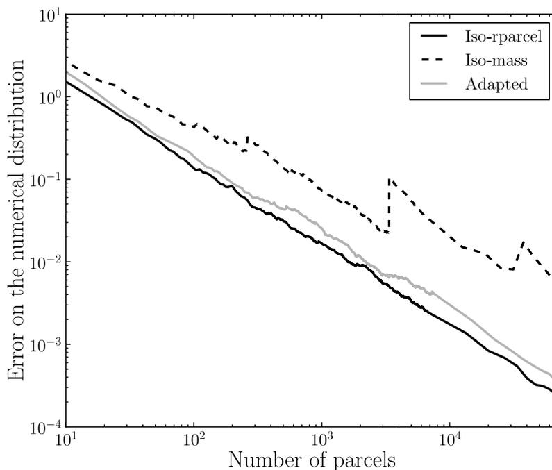
**Figure 7.4 :** Evolution de l'erreur au sens des moindres-carrés sur la distribution **en nombre**, en fonction du nombre de particules numériques injectées, pour les trois différentes méthodes. Les valeurs des régressions linéaires sur ces résultats sont données en Tab. 7.1.
