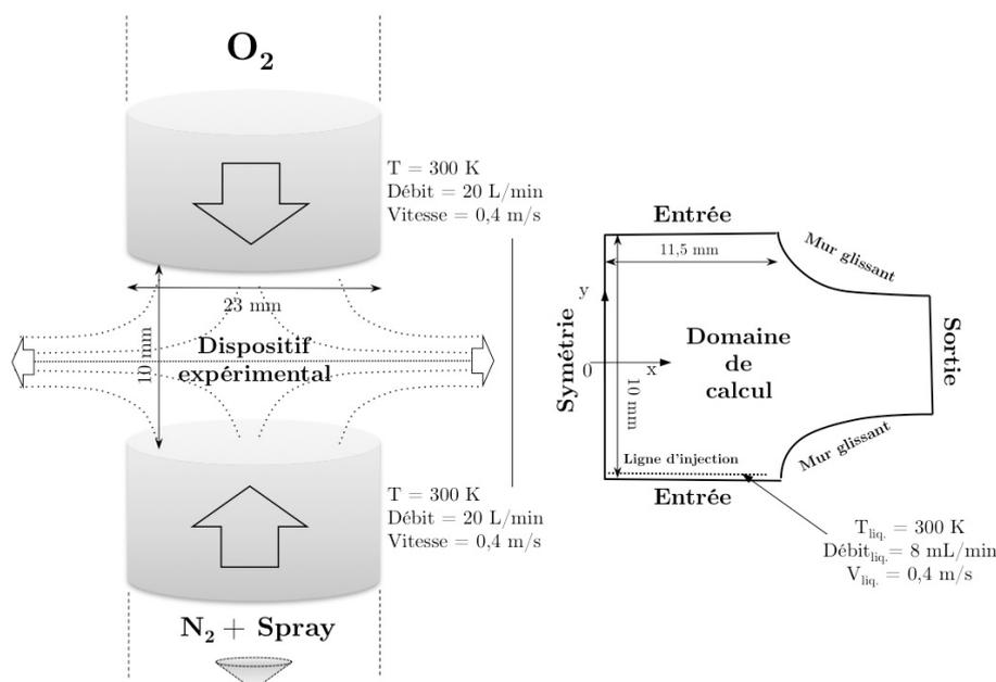
**Figure 9.3 :** Schéma du dispositif expérimental de Mikami et al. [143] (gauche) et du domaine numérique et des conditions limites associées (droite).
