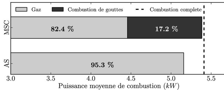
**Figure 12.4 :** Puissance moyenne du brûleur pour les deux modèles, par rapport à la puissance issue de la combustion complète du carburant injecté. Pour le modèle *MuStARD*, la puissance est générée par les contribution de la combustion gazeuse et de la combustion de goutte isolée.
