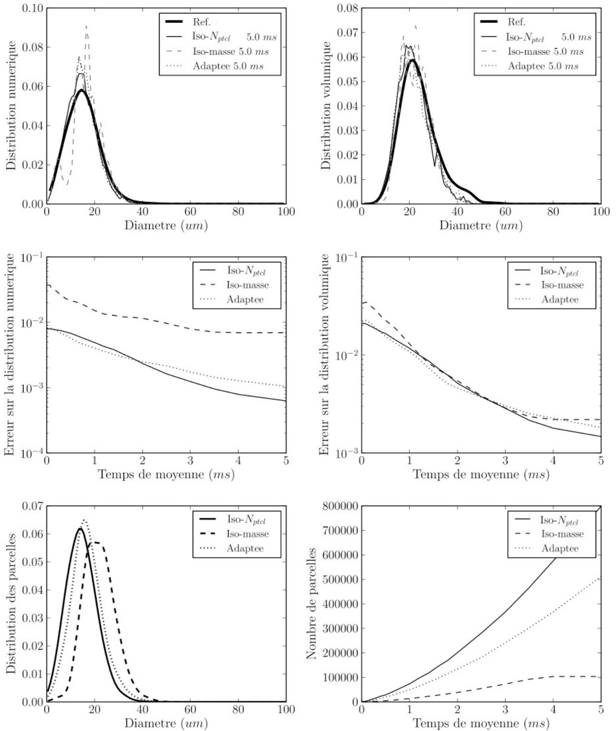
**Figure 7.11 :** Population locale dans la boîte III (Fig. 7.8) pour les trois méthodes. Dans l'ordre : distribution en nombre, en volume par rapport à la population de référence (16 ms de convergence), erreur sur la distribution en nombre, en volume, distribution des particules numériques et nombre de particules numériques comptées en fonction du temps de moyenne.
