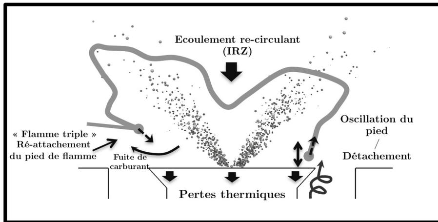
Figure 11.16 : Schéma du mécanisme de stabilisation de flamme des branches I et II (Fig. 11.11).
