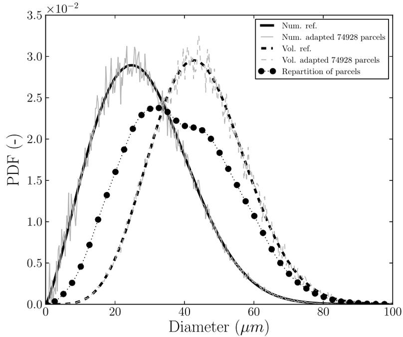
**Figure 7.6 :** Méthode adaptée : distribution en nombre et en volume obtenues après injection d'un grand nombre de particules numériques, par rapport à la distribution physique de référence (Rosin-Rammler). La répartition des particules numériques se situe entre la distribution en nombre et en volume dans cette méthode.
