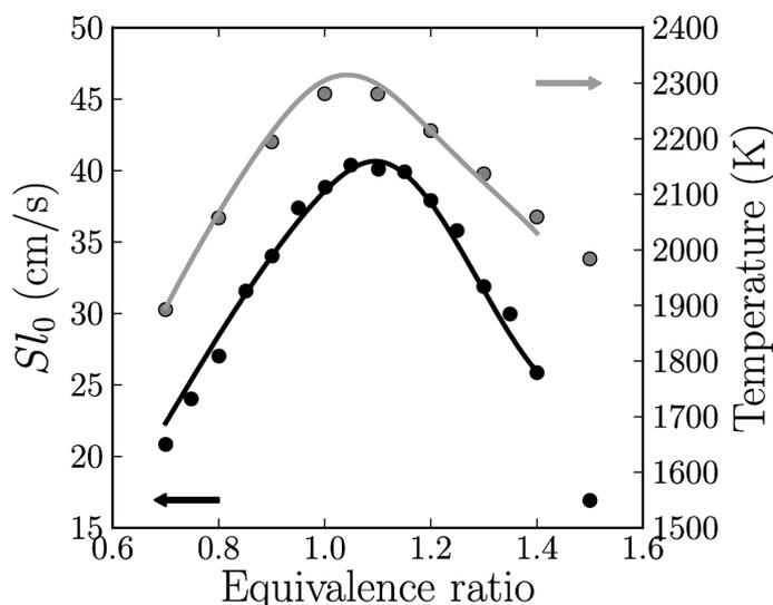
**Figure 9.6** : Validation du schéma réduit *2S\_C7H16\_DP*. Symboles : chimie détaillée [192]. Ligne : *2S\_C7H16\_DP*. Vitesse laminaire de flamme (noir), et température adiabatique de fin de combustion (gris).
