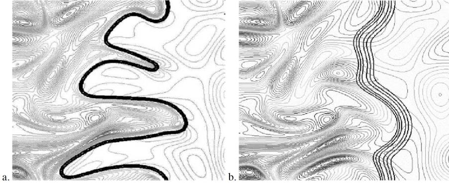
**Figure 3.3 :** Illustration d'un front de flamme épaissie (droite) afin d'être résolu sur le maillage LES. On notera le défaut de plissement de la flamme associé à l'opération d'épaississement, qui est récupéré à travers le modèle d'efficacité.
