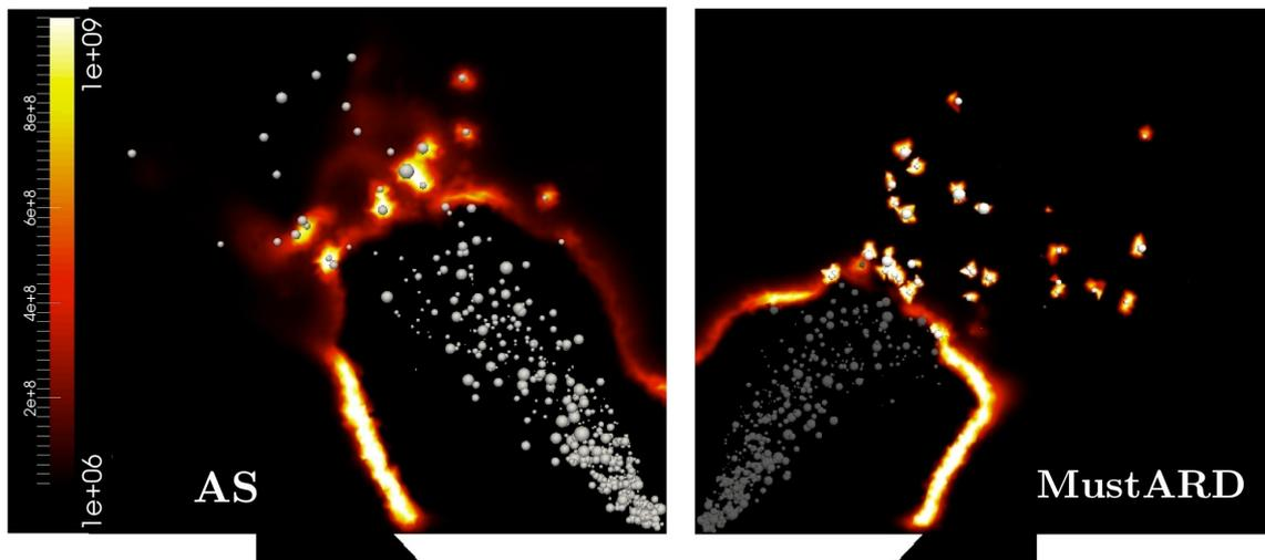
**Figure 12.11** : Dégagement de chaleur instantané, avec sur-imposition des gouttes, dont la taille est proportionnelle au diamètre de goutte. Pour MuStARD, le mode E est activé pour les gouttes colorées en blanc.
