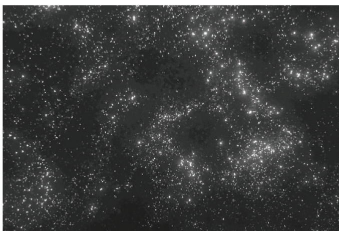
Figure 2.3 : Illustration de la ségrégation préférentielle des gouttes : image expérimentale d'une nappe laser traversant un spray de gouttes ayant un nombre de Stokes proche de 1, dans une turbulence homogène isotrope (tirée de [221]).
