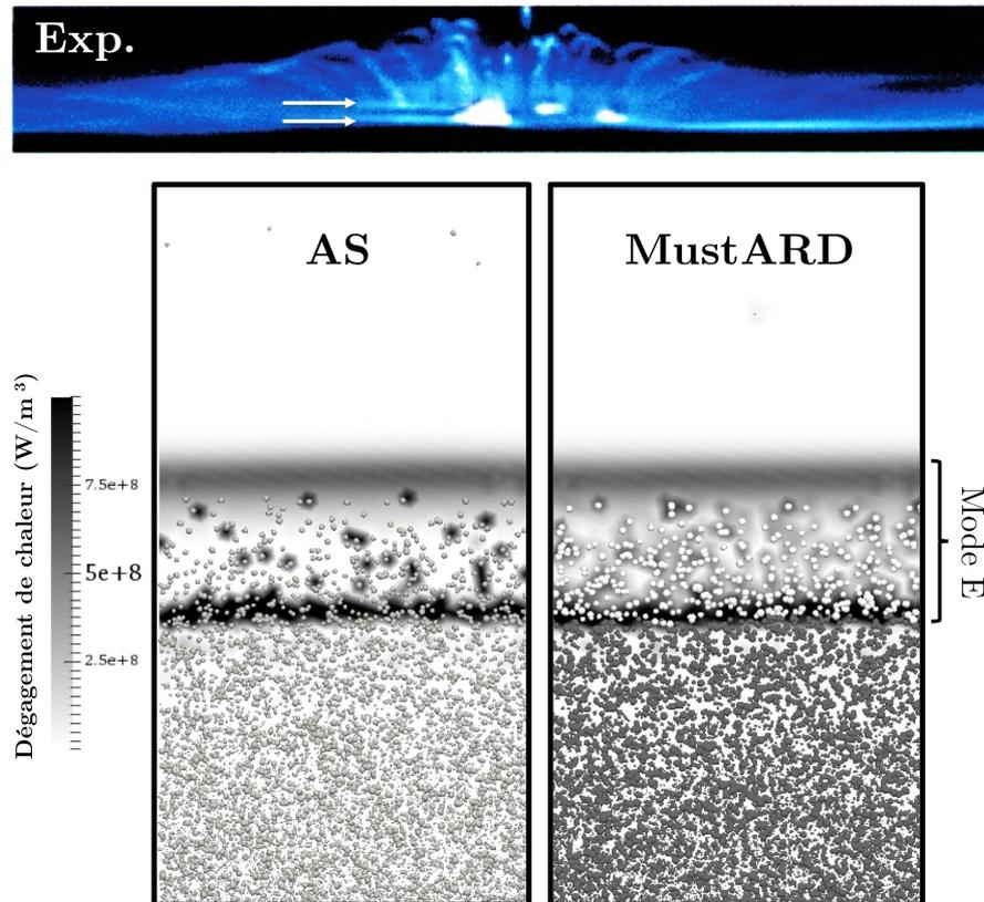
**Figure 9.7 :** Flamme à contre-courant de Mikami et al.. Haut : photographie dans l'expérience de la flamme avec un temps de pose de 33 ms (extrait de [143]). Bas : champs instantanés de dégagement de chaleur total proche de l'axe de symétrie pour les simulations *MuStARD* et *AS*, dans le cas avec oxygène pur [143]. Les gouttes sont superposées et sont colorées selon leur état V (gris) ou E (blanc) dans la simulation *MuStARD*.
