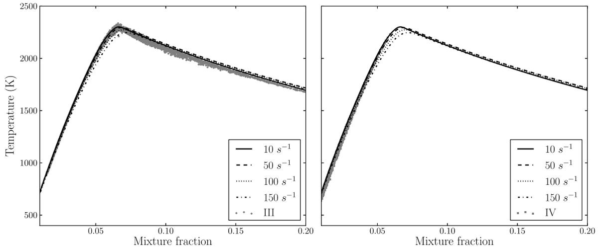
**Figure 11.24 :** Température et fraction de mélange, obtenues pour les branches III (droite) et IV (gauche) (Fig. 11.11) dans la LES.
