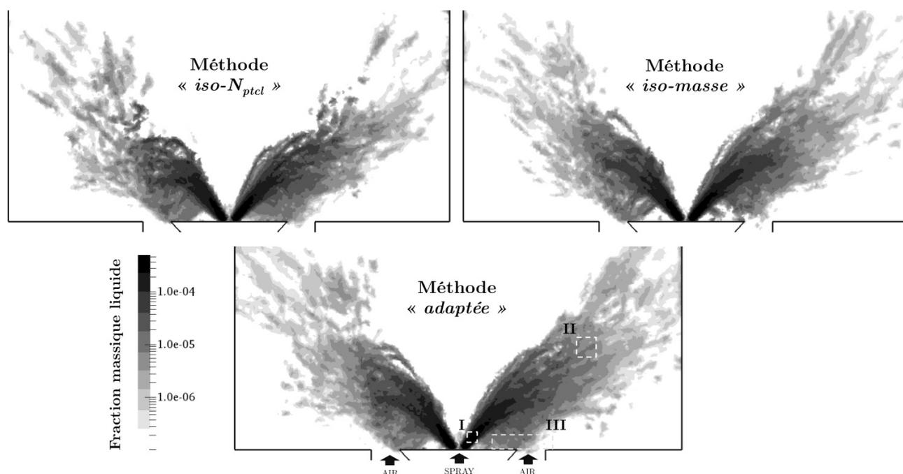
**Figure 7.8 :** Champ moyens de fraction volumique liquide, dans une coupe verticale centrée sur l'injecteur, pour les trois méthodes. Les trois boîtes blanches correspondent aux zones d'études plus détaillées des populations locales de gouttes.
