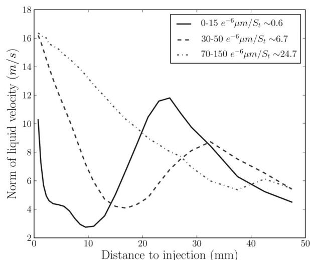
**Figure 11.18 :** Evolution de la vitesse moyenne des gouttes le long l'axe central de la chambre. Moyennes obtenues dans des plans successifs, perpendiculaires à l'axe, pour trois classes de diamètre de goutte.
