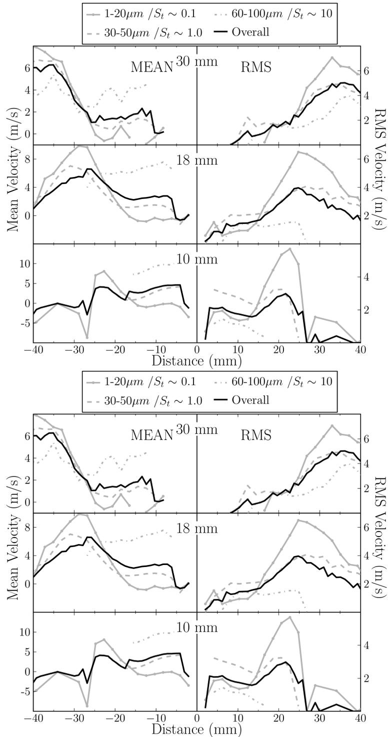
**Figure 11.10 :** Cas réactif avec spray : profils de vitesse **liquide** moyenne (gauche) et fluctuante (droite) axiale (haut) et tangentielle (bas) pour trois hauteurs différentes dans la chambre (cf. Fig. 11.4), pour trois classes de diamètre de goutte, comparés à la moyenne totale.
