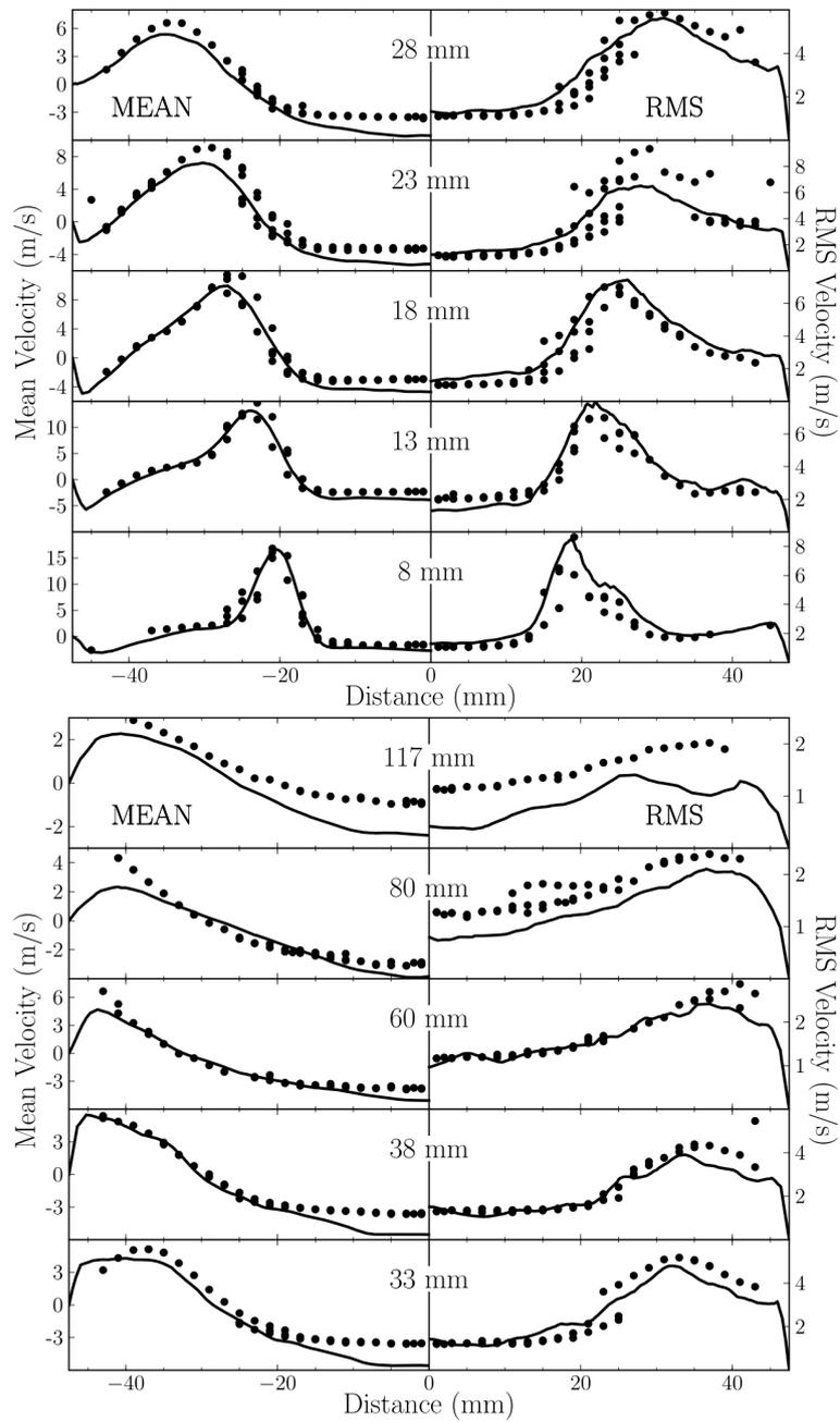
**Figure 11.1** : Cas non réactif purement gazeux : LES (lignes) versus expérience (symboles) [204]. Profils axiaux de vitesse gazeuse moyenne et fluctuante à différentes hauteurs dans la chambre (Fig. 11.3).
