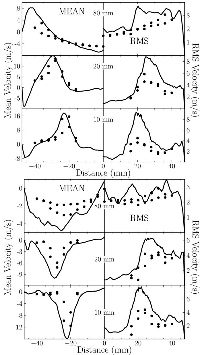
**Figure 11.8 :** Cas réactif avec spray : LES-DPS (lignes) vs. expérience (symboles) [204]. Profils de vitesse gazeuse moyenne (gauche) et fluctuante (droite) axiale (haut) et tangentielle (bas) pour trois hauteurs différentes dans la chambre (cf. Fig. 11.4).
