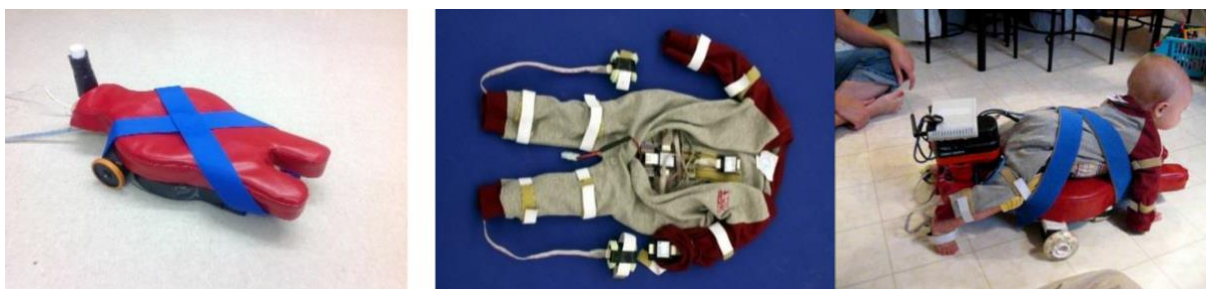
Figure 5 – « Self-Initiated Prone Progression Crawler (SIPP) system » (à gauche); la combinaison « SIPP Suit » (au milieu); et un nourrisson utilisant le « SIPP system » (à droite), (Kolobe & Fagg, 2019).
