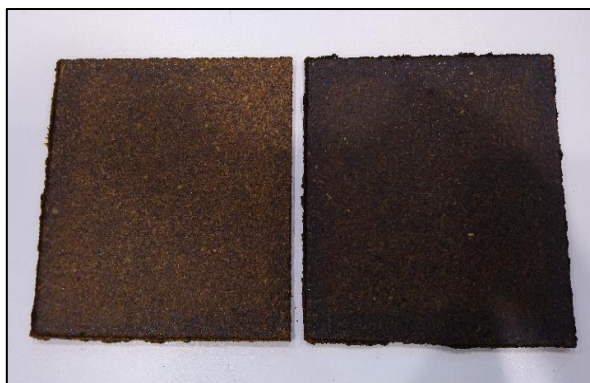
Figure IV-2 : Aspect des panneaux de fibres (carrés de 15 cm de côtés) fabriqués à partir des drêches brutes à 180°C et 200°C (de gauche à droite)
