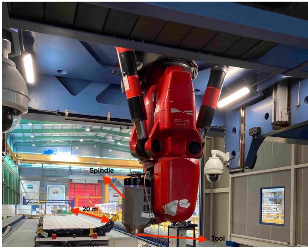
Figure 4.2. Processus de fraisage d'une paroi de voiture de train TGV (longueur \approx 20 mètres).
