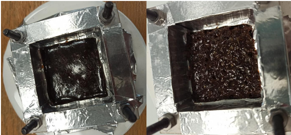
Figure 40 : Adhésif réticulé dans le moule (à gauche), adhésif réticulé puis moussé en différé (à droite)
