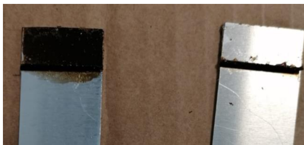
Figure 106 : Faciès de rupture des différentes formules adhésives étudiées avant moussage après essai de cisaillement en simple recouvrement, 1 mm/min
