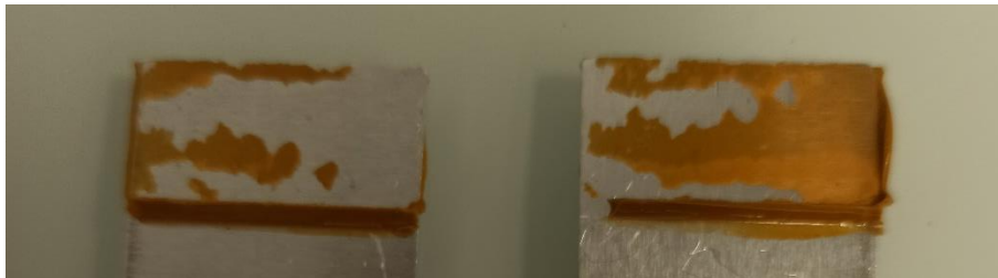
Figure 104 : Faciès de rupture de la formule 3M seule après essai de cisaillement en simple recouvrement, 1 mm/min
