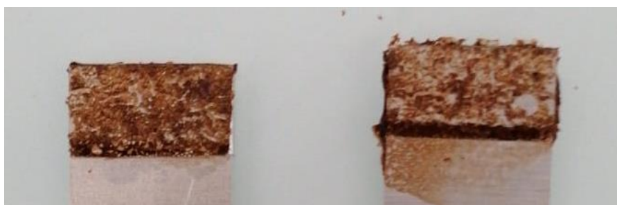
Figure 110 : Faciès de rupture des différentes formules adhésives BADEPO avec et sans 3M étudiées après moussage après essai de cisaillement en simple recouvrement, 1 mm/min
