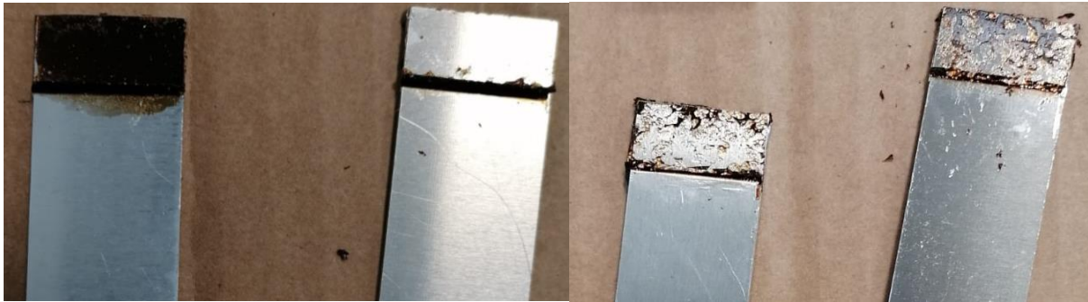
Figure 108 : Faciès de ruptures de l'adhésif BADEPO/IPDA seul et en situation stœchiométrique. Rupture adhésive si non moussé (à gauche), rupture mixte/cohésive si moussé (à droite)
