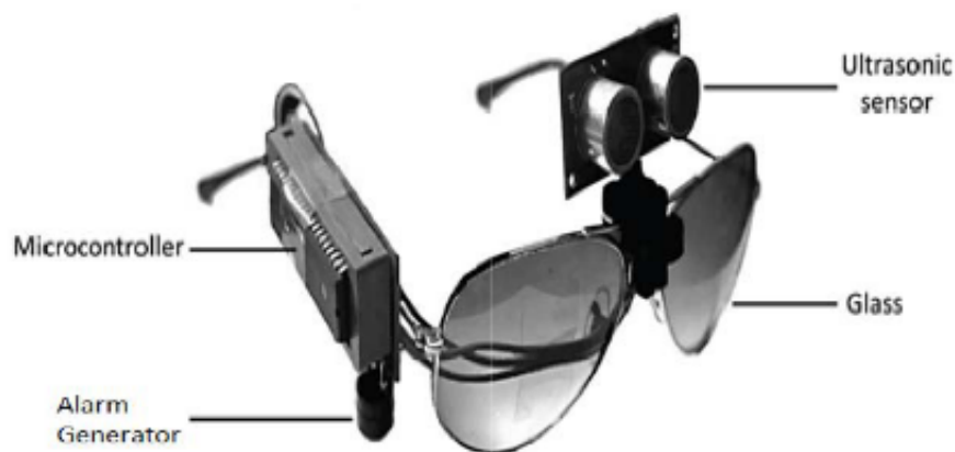
FIGURE 3.1 – Le prototype de restitution sonore d'informations de proximité aux objets de Sadi et al. Il est composé d'un capteur ultrasons, d'une alarme et d'un boîtier de calcul. [Sadi et al., 2014].
