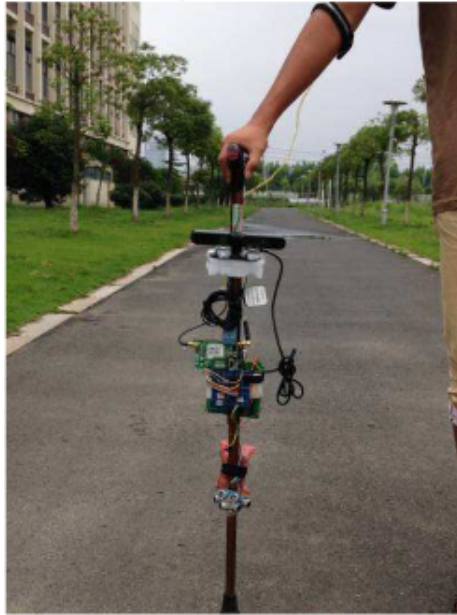
FIGURE 3.7 – Canne utilisée lors de l'expérience de Fan et al. Elle est composée d'une caméra RGB-D et d'un capteur à ultrasons[Fan et al., 2014].
