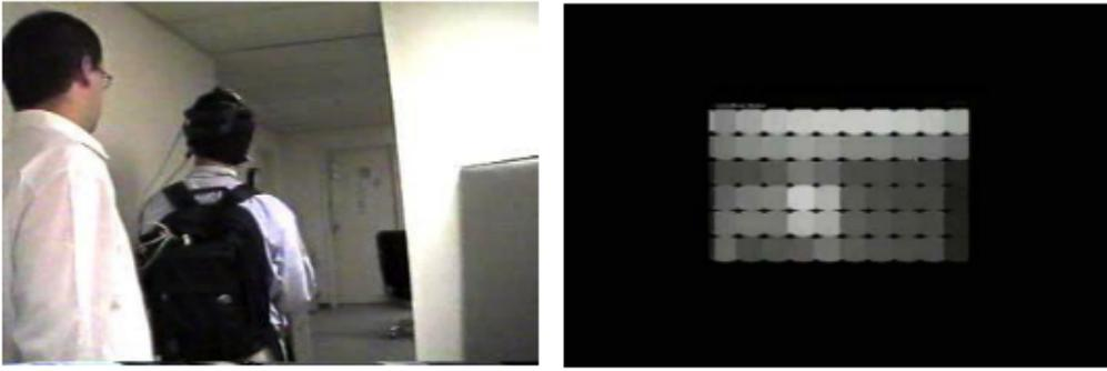
FIGURE 1.34 – Image de la première expérimentation de Dagnelie et al. À gauche, l’environnement réel et, à droite, l’environnement restitué sous forme de phosphènes [Dagnelie et al., 2007].
