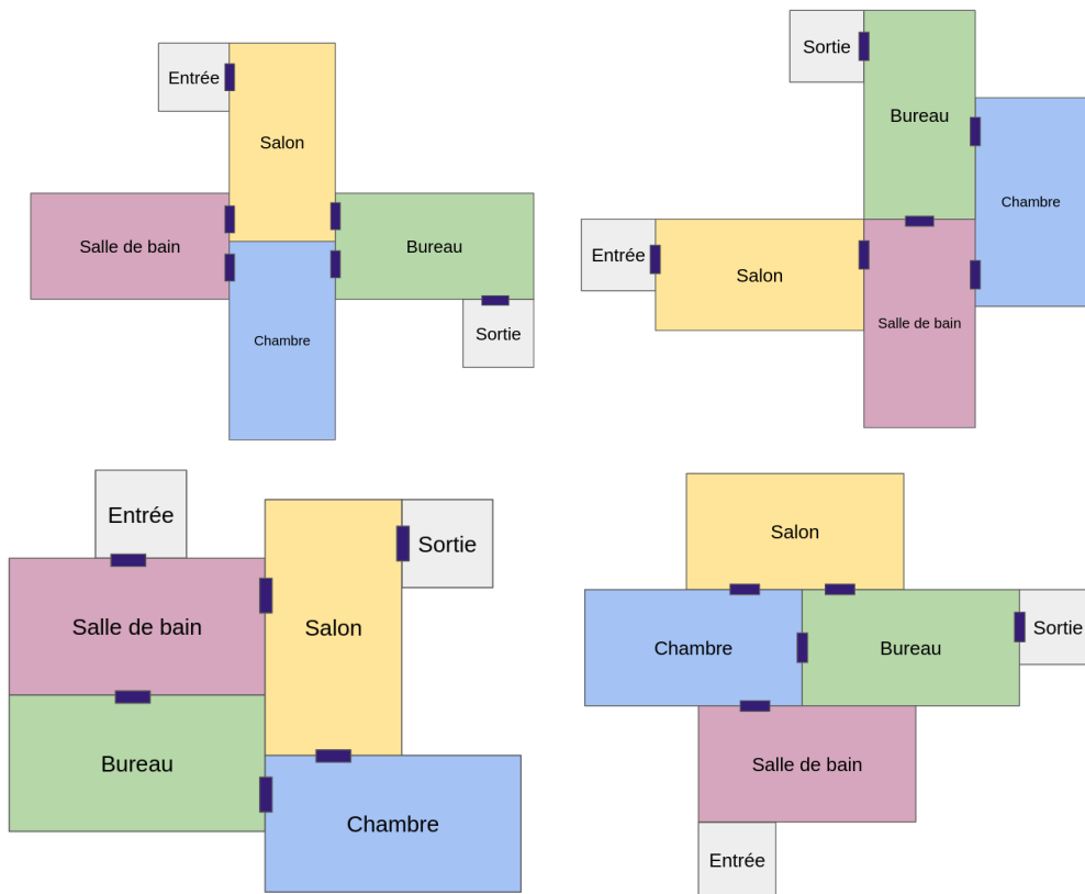
FIGURE 3.9 – Schéma des quatre scènes choisies dans le cadre de cette étude. On retrouve à chaque fois les quatre pièces modélisées et meublées d’objets répartis aléatoirement à l’intérieur (salon, salle de bain, chambre, bureau). Les cellules d’entrées et de sorties sont représentées en gris. Les rectangles bleu foncé représentent les portes qui permettent de passer d’une pièce à une autre.
