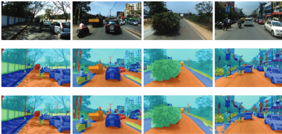
FIGURE 1.50 – Exemple de résultats de segmentation sémantique sur des images d'extérieur avec un réseau ResNet-50 comme encodeur. La première ligne montre les images d'entrée et la deuxième ligne montre la vérité terrain. La troisième rangée montre le résultat de la segmentation sémantique où différentes couleurs correspondent aux différentes classes [Baheti et al., 2019].
