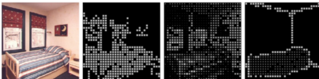
FIGURE 4.1 – Exemple de rendu basé sur l'approche proposée par Sanchez-Garcia et al. Les images représentent dans l'ordre, l'image de base, une restitution phosphénique basée uniquement sur une détection par filtre de Sobel, une restitution phosphénique basée sur une technique du type Scoreboard et l'image proposée par leur méthode SIE-OMS [Sanchez-Garcia et al., 2020].
