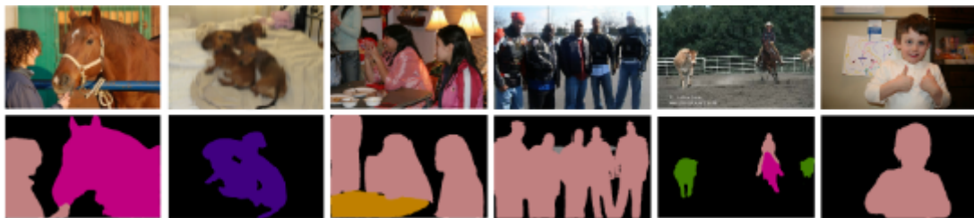
FIGURE 1.51 – Exemples de résultats de segmentation sémantique en utilisant le réseau DeepLab V3+. La première ligne montre les images d'entrée et la seconde ligne montre les prédictions réalisées par le réseau [Chen et al., 2017].
