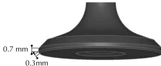
Figure A.19: Caractéristiques géométriques de la tête de soupape d'échappement du moteur ECOSURAL.
