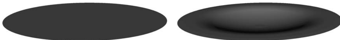
Figure 7.19: Vue des pistons dans le moteur ECOSURAL. Version moteur optique utilisée pour les points de fonctionnement sans combustion à gauche et version moteur opaque utilisée pour les points de fonctionnement avec combustion à droite.
