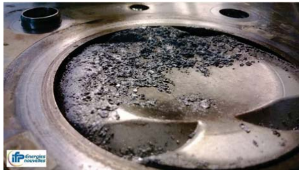
Figure 1.6: Erosion du piston par cliquetis (source IFP Energie Nouvelles ).
