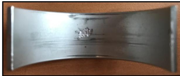
Figure 3.33 : Ecaillage du coussinet avec un effort de 74 kN appliqué au vilebrequin. Essai réalisé dans le banc MAPH.
