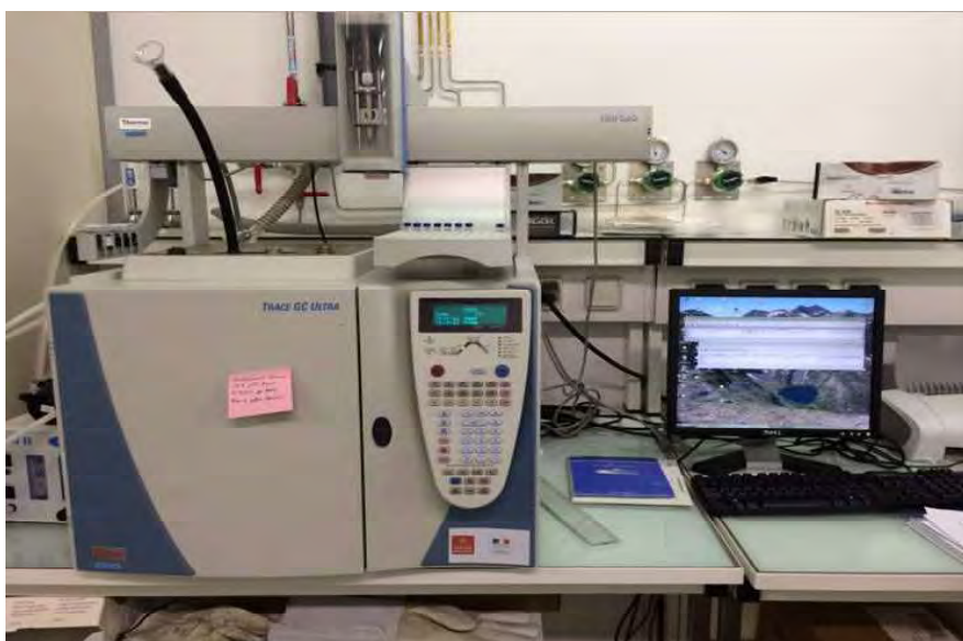
FIGURE 5.4.2: Photographie de la chromatographie en phase gazeuse couplée à la détection par ionisation de flamme.
