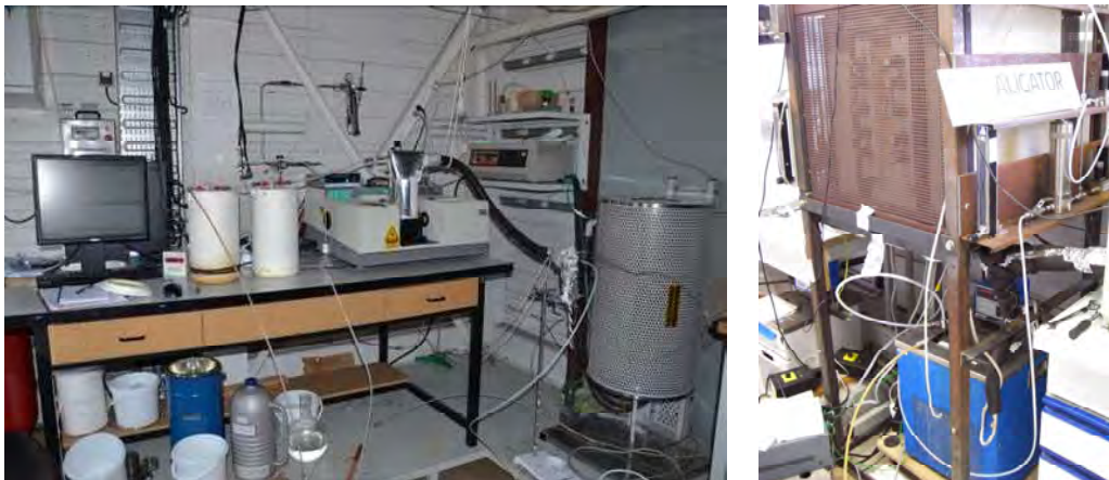
(a) Photo du réacteur TORNADO au CEA (Grenoble). (b) Photo du réacteur ALIGATOR au CIRAD (Montpellier).
