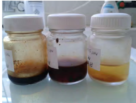
FIGURE 5.1.4: Photographie des condensats de torréfaction après les deux étages, de K. Lê Thành (CIRAD). A gauche : condensats en sortie du premier étage de condensation. Au milieu : condensats en sortie du second étage de condensation. A droite : condensats issus de l'absorption dans l'eau de l'effluent gazeux sortant des deux condenseurs.
