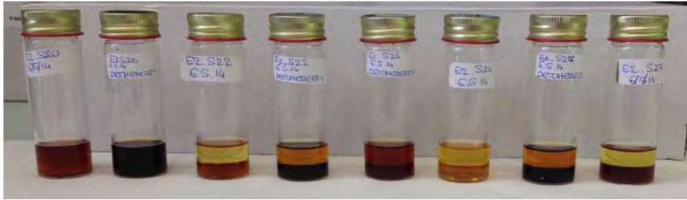
FIGURE 3.2.2: Expériences de miscibilité des condensats de torréfaction dans différents solvants.
