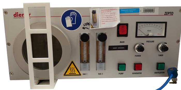
FIGURE 2.9 – Cuve à plasma sous vide.
