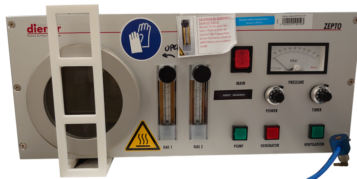
FIGURE 2.9 – Cuve à plasma sous vide.
