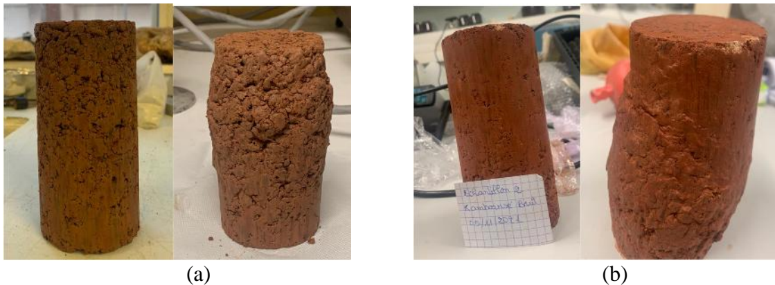
Figure 3-6 : Photos d'illustration des échantillons bruts avant et après essai : a) Saaba (C2_S), b) Kamboinsé (C1°K)
