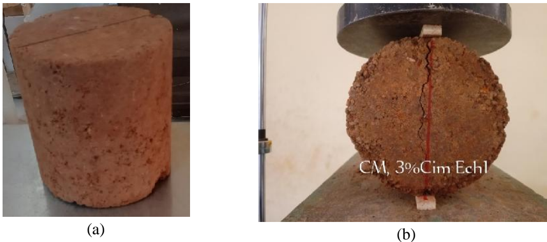
Figure 2-12 : Epreuve a) Après confection, b) soumise à la traction indirecte
