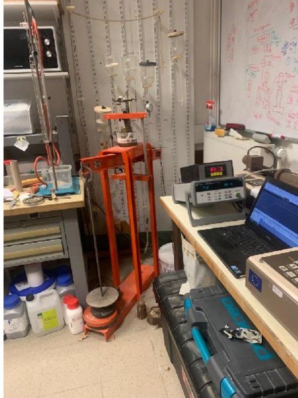
Figure 2-19 : Appareil œdométrique ; cellule, capteurs numérisés et dispositif de chargement
