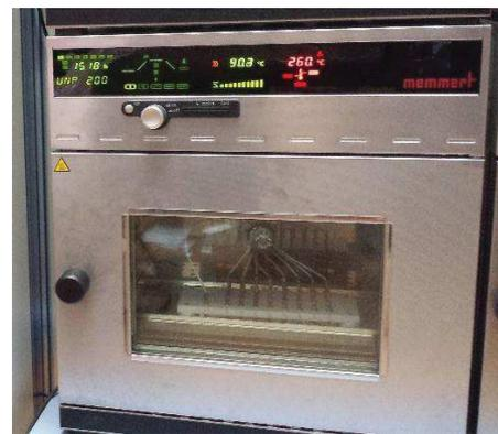
Fig. II.12 b. Chambre climatique utilisée dans la 2<sup>ème</sup> campagne d'essais
