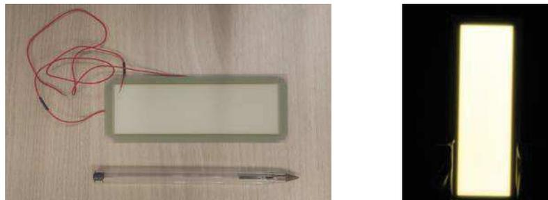
Fig. II.21 Photos d’une OLED Philips GL55
