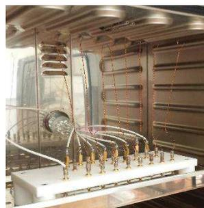
Fig. II.13 b. 8 paires placées dans la chambre climatique
