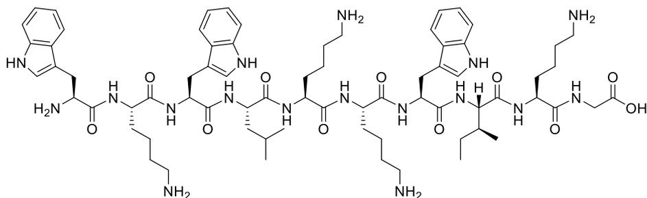
La synthèse du peptide NH<sub>2</sub>-WKWLKKWIKG-OH est réalisée à l'aide du protocole Fmoc/tBu sur un synthétiseur automatique de peptides à micro-ondes Biotage® Initiator+ Alstra™ sur une échelle de 0,25 mmol sur résine 2-Chlorotrityl chloride.
