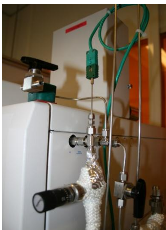
Figure III.17: Thermocouple et cordon chauffant à l'entrée du chromatographe
