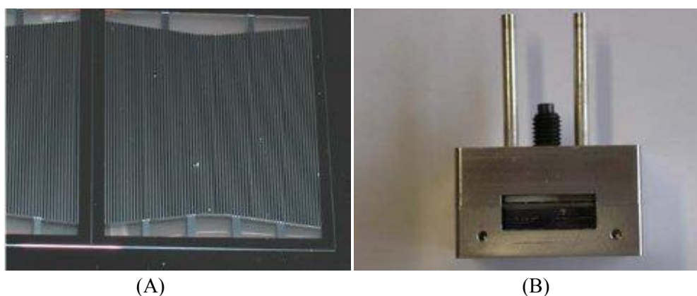
Figure III.20: (A) Plaque microstructurée dans le R4, (B) Microréacteur R4
