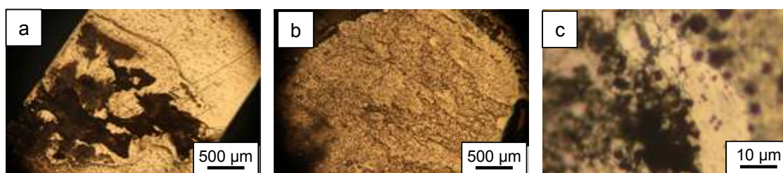
Figure IV- 51: Observations du plan L-TL (a) du métal de base, (b) de la ZAT et (c) du Noyau soudé du joint soudé T34 OPT Post-traité après un essai de corrosion sous contrainte durant 3 jours dans une solution à 0,7 M de NaCl thermostatée à 25 °C.
