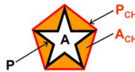
FIGURE 2.18: Aire A_{CH} et périmètre P_{CH} de l'enveloppe convexe d'une forme d'aire A et de périmètre P
