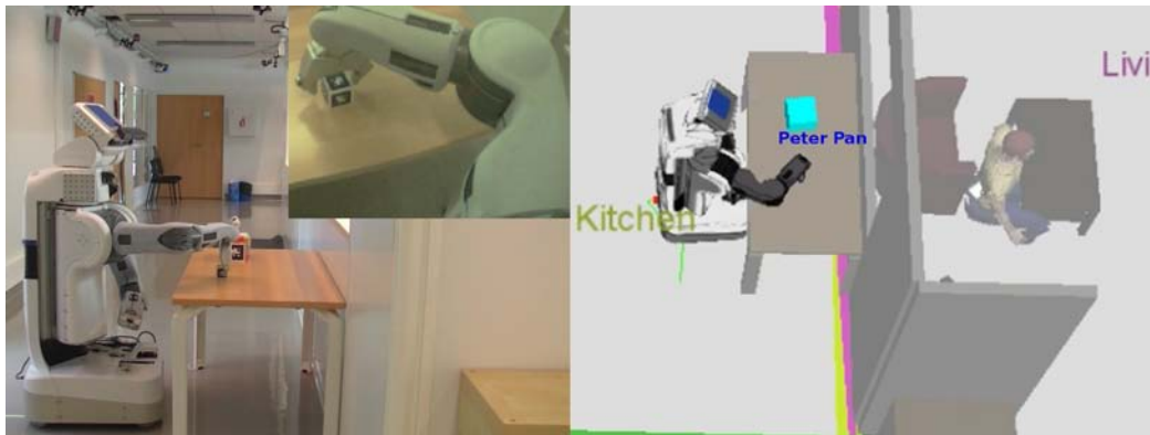
FIGURE 4.16 – Le robot propose de ramener le livre de Peter Pan (ici représenté par un cube pour faciliter la manipulation) car il n'a pas trouvé Cendrillon et que ces deux objets sont proches car ils ont le même type (livre) et le même genre (conte pour enfant). L'image de gauche montre le robot attrapant l'objet dans le monde réel et l'image de droite montre la même scène dans Rviz.
