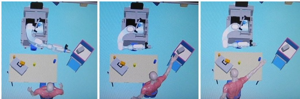
FIGURE 3.5 – Exemple d'état du monde où le système calcule si les agents sont capables d'atteindre un objet. Sur l'image de gauche, le robot est capable de calculer qu'il peut attraper l'objet gris. Il calcule également que l'homme peut attraper l'objet gris, comme illustré par l'image centrale. Si l'homme avait été placé plus loin, le robot aurait pu calculer que l'objet était inaccessible pour l'homme, comme illustré par l'image de droite.
