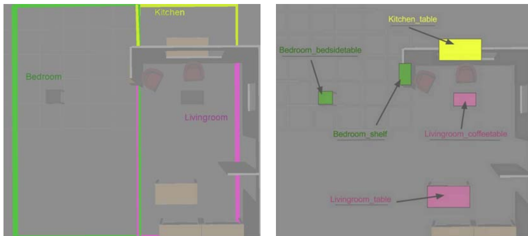
FIGURE 4.12 – Répartition des différentes pièces (image de gauche) et des différentes zones de manipulation correspondants aux meubles contenus dans ces pièces (image de droite).
