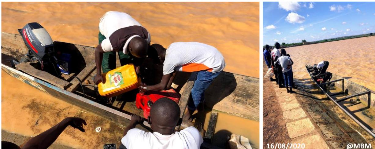
Figure 2. 25 : Préparatifs de pirogue pour les mesures (en transect et section) en crue rouge du Niger ; site de Saga 16/08/2020 (débit = 2 740 m<sup>3</sup>/s). Le Niger avait atteint et dépassé le niveau d'alerte rouge fixé à 6,20 m (débit = 2 512 m<sup>3</sup>/s) le 12/08/2020.
