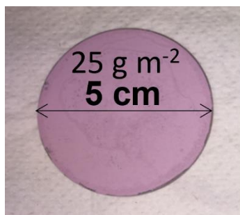
Figure 3.3 : Photographie d'un échantillon Au 1%/TiO 2 UV 100 déposé par drop casting sur un disque en quartz.
