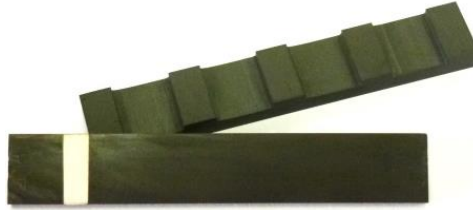
Figure 5.12 : Transformateur inter-cellules (ICT) réalisé sur mesure à partir de barreau de ferrite Epcos N87
