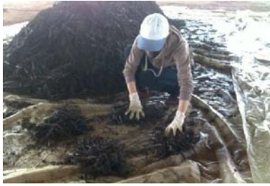
Figure 2: Echantillon global Homogénéisé divisé en quatre parts équivalentes
