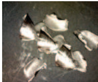
FIGURE 2.10 – Copeaux fragmentés et quasi-fragmentés obtenus lors d'un essai avec f=0.2\text{mm/tr} et a=0.25\text{mm}
