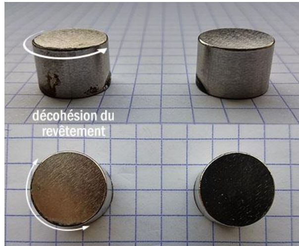
Figure III-14 : Comparaison entre un plot montrant la décohésion du revêtement en \text{Cr}_x\text{C}_y amorphe au niveau de l'arête supérieure repérée par une flèche et un autre plot sain (revêtements déposés à 450\text{ }^\circ\text{C} et 6,7 \cdot 10^3\text{ Pa} )
