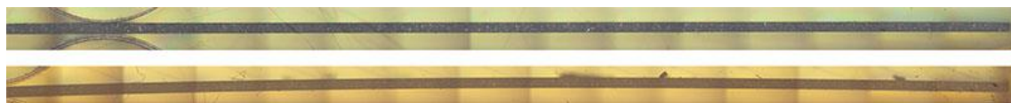
Figure VI-5 : Vue en tranche d'une éprouvette avant (en haut) et après (en bas) dépôt du revêtement sur la face supérieure, ici des carbures de chrome amorphes. L'éprouvette est maintenue à gauche par un clip métallique.
