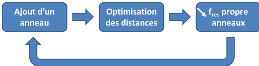
Figure I-46: Synoptique de conception de l'antenne proposée dans [I-51]
