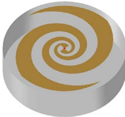
**Figure I-9: Antenne log-spiral sur cavité [I-7]**
