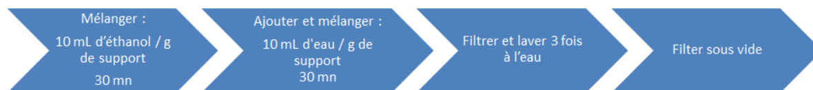
Figure 31 : Méthode d'activation des supports de type Accurel® MP
